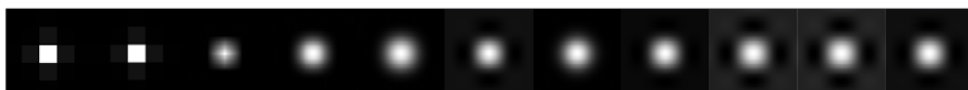
从左到右调整滤镜的大小:近邻、方形、线性、二次方、三次方、Catmull-Rom、Gaussian、Mitchell、Lanczos、Sinc和Bessel
