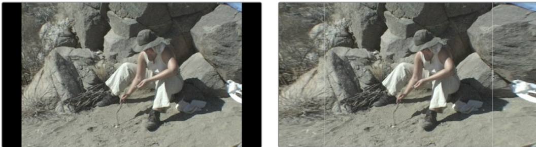
(左图) 4:3宽高比的原始素材编辑到16:9宽高比的“时间线”上, 采用左右加黑边填充, (右图) 画面的“缩放模式”设为“顶部图层变形”, 拉伸左右边缘以填充空白区域
