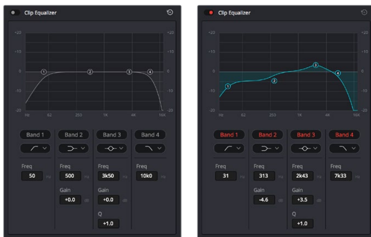
通道条“均衡器”调节面板，左图EQ未调整，右图EQ进行了调整
