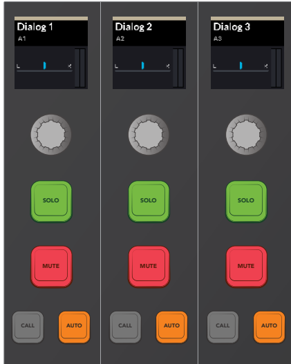
“通道推子”上的“LCD显示屏”、“推子声像”旋钮和“推子通道”控制按钮。
