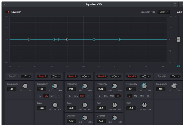
可以对每条“轨道”应用6段参数均衡器
