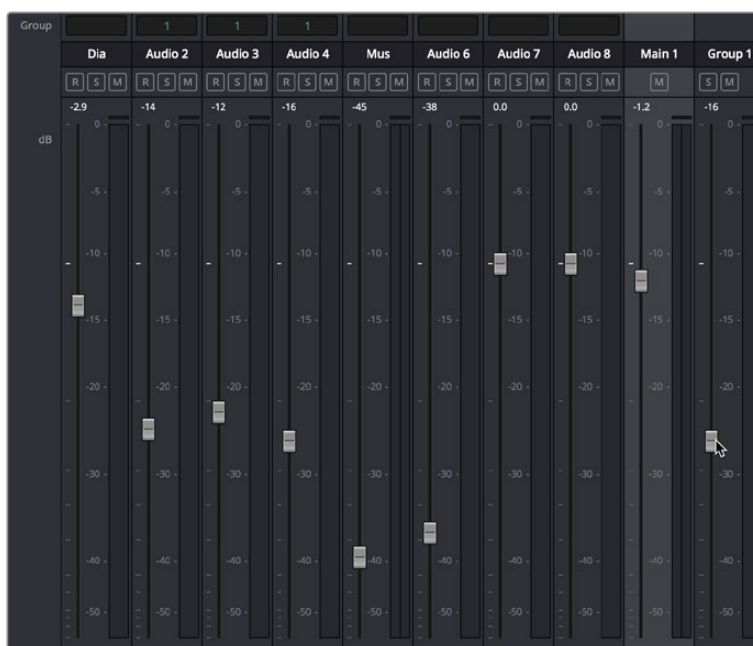
调整“编组1”推子，即同时调整分配给“编组1”的“音频1”、“音频3”和“音频4”通道的电平。
