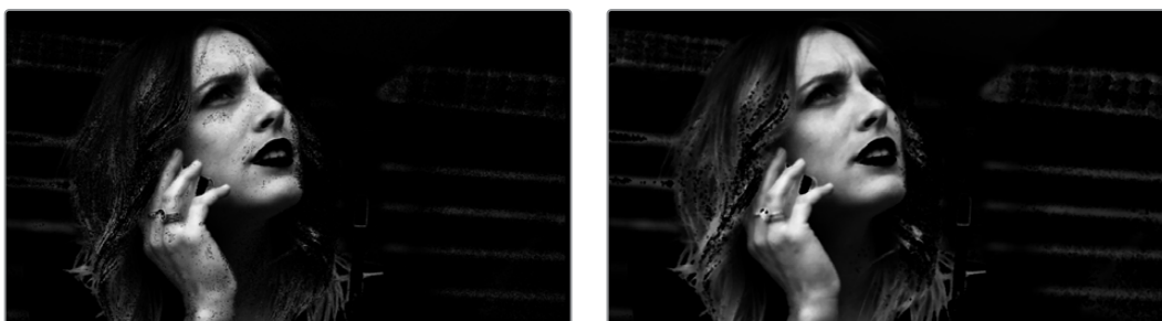
(左图)脸部带有小空洞的蒙版，(右图)“模式”设置为“收缩”，“形状”设置为“圆形”，“半径”设置为3，“重复次数”设置为3，用以闭合蒙版中的空洞
