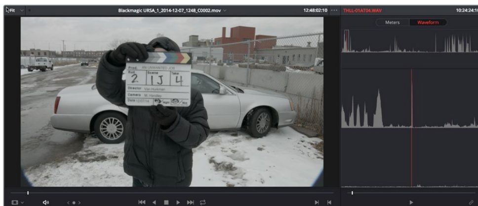
音频面板上显示波形以对齐视频和音频同步点
