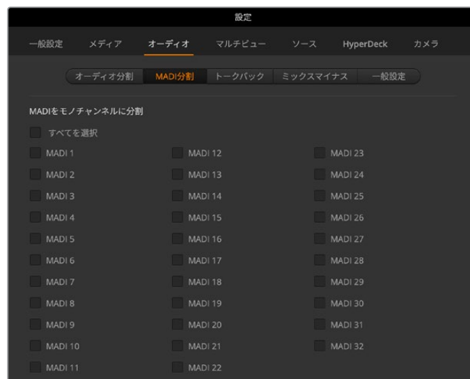
ATEM 4 M/E Constellationスイッチャーで、チェックボックスを使用して、MADIを個別のモノチャンネルに分割
