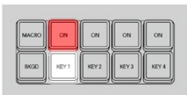
Panel sterowania z przyciskami następnego przejścia przed przejściem.
