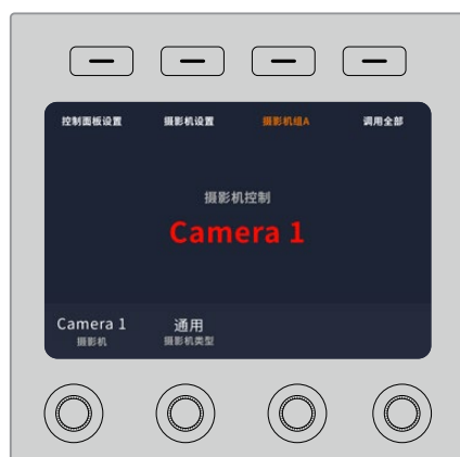
LCD主菜单屏幕上的摄影机名称和号码可显示当前每个CCU控制单元各自所选的摄影机。
