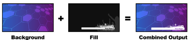
Совмещение фона и вырезающего/заполняющего сигналов при яркостном кейнге
