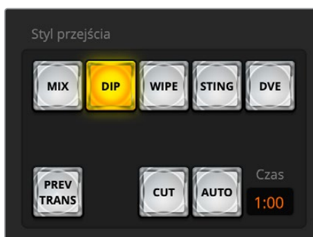
Przycisk cięcia jest częścią grupy Style przejść
