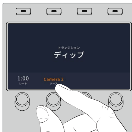
トランジションコントロール・ブロックの「DIP」ボタンを押し、LCDメニューとコントロールノブでディップソースおよびトランジションレートを設定
