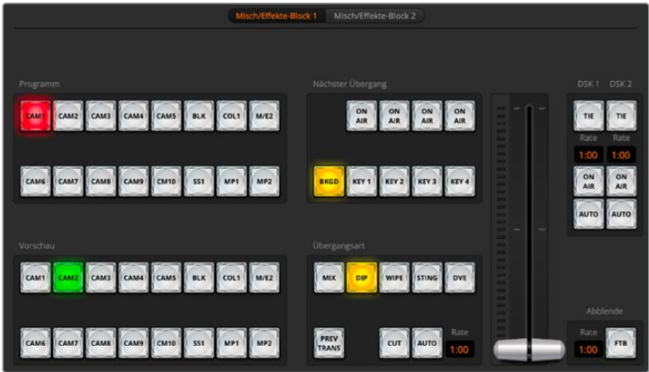
Selektieren Sie bei ATEM 2 M/E und 4 M/E Modellen den Misch/Effekte-Block mit den nummerierten Buttons am oberen Rand der Benutzeroberfläche
