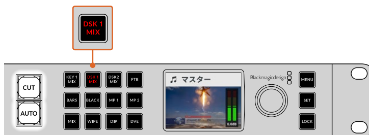
「DSK 1 MIX」ボタンを押してダウンストリームキー1をオンエア/オフエアにフェード
