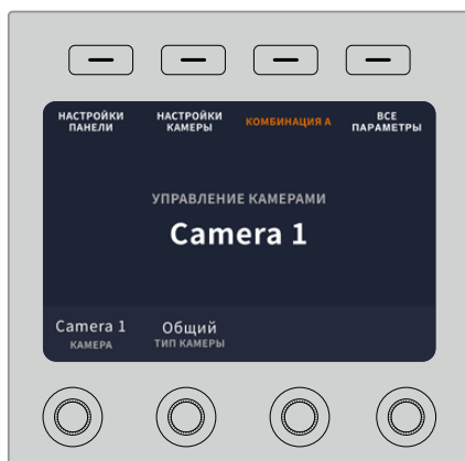
Начальная страница позволяет устанавливать настройки, выбирать нужную комбинацию камер и использовать заданные параметры для всех камер
