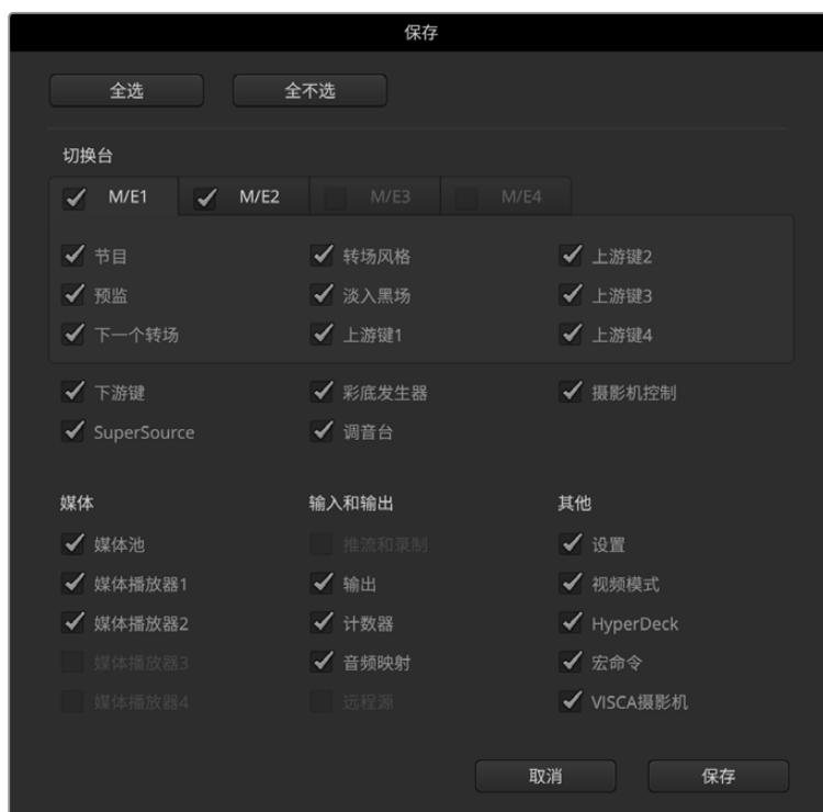
ATEM Software Control软件控制面板可以保存和恢复切换台现场制作时的所有设置, 包括键设置、转场风格、媒体池内容等
