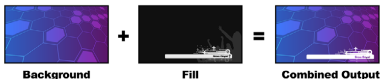
Łączenie tła i wypełnienia/klucza w kluczu luma
