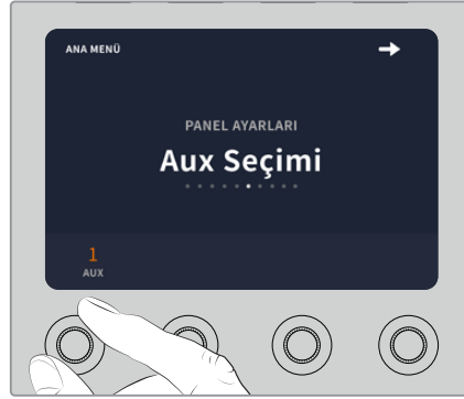
Kamera kontrol için özel bir auxiliary çıkışı atamak üzere 'aux seçimi' düğmesini çevirin.
