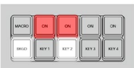
图为控制面板中Next Transition下一个转场按钮在转场前的状态。
