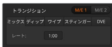
ミックストランジションのレート設定
