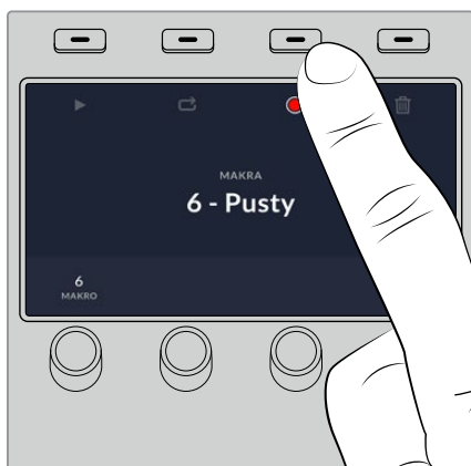
Naciśnij przycisk ekranowy ZAPISZ , aby rozpocząć nagrywanie makra
