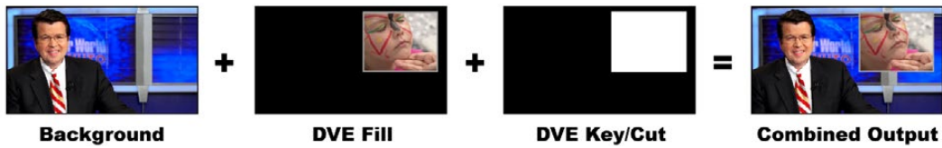
Bir arkaplan, DVE fill ve DVE key/cut birleştirme
