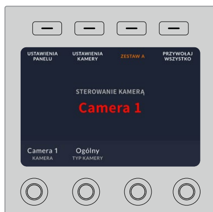
Nazwa i numer kamery na ekranie głównym LCD pokazuje aktualnie wybraną kamerę dla każdego CCU
