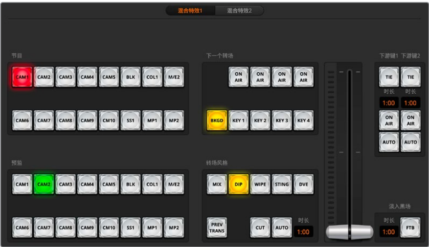
在ATEM 2 M/E和4 M/E型号上, 通过界面顶部的含有数字的按钮来选择混合特效面板
