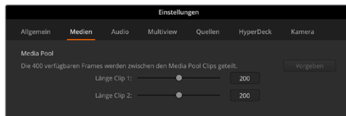
Teilen der Speicherkapazität des ATEM 2 M/E Constellation HD
