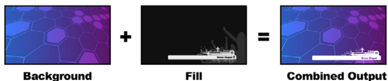
Kombinieren eines Hintergrunds mit Füll- und Stanzsignalen in Form eines Luma-Keys
