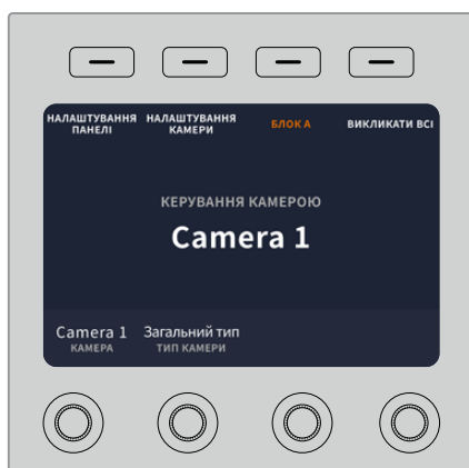
Головна сторінка дозволяє встановлювати налаштування, вибирати потрібну комбінацію камер і використовувати задані параметри для всіх камер
