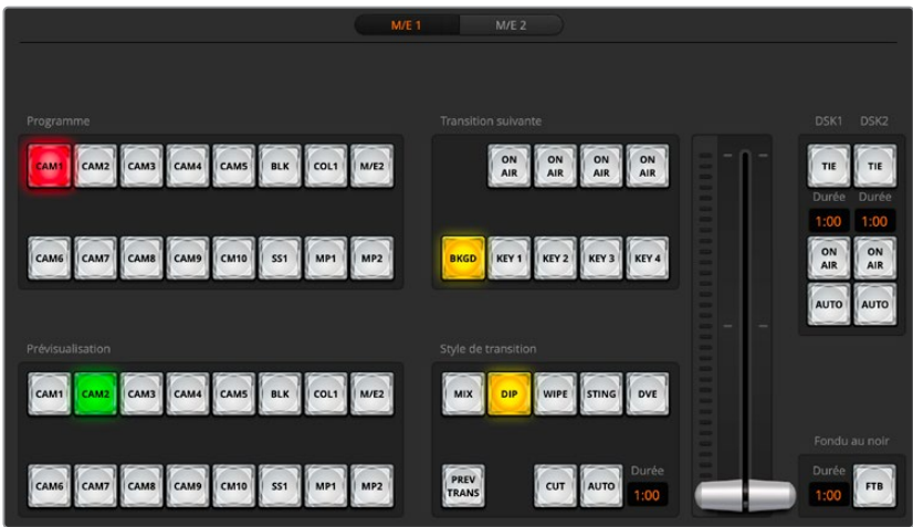
Sur les modèles ATEM 2 M/E et 4 M/E, sélectionnez le panneau M/E à l'aide des boutons numérotés en haut de l'interface
