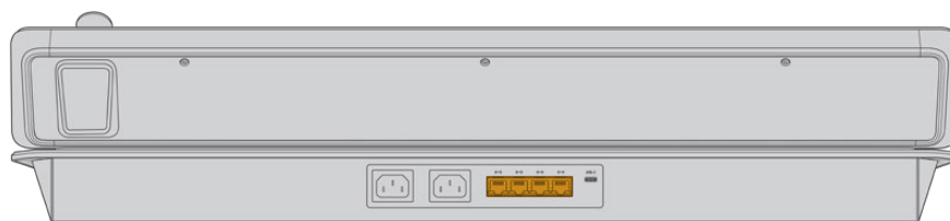
Порти Ethernet на пульті ATEM 2 M/E Advanced Panel
