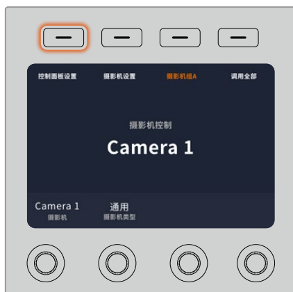
按下LCD屏幕主页上的“设置”多功能按钮可进入摄影机控制面板所有设置
