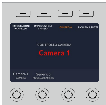
La voce CAMERA nella home del display LCD mostra la camera assegnata alla CCU
