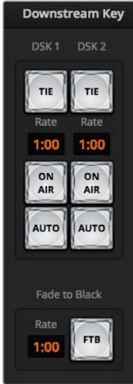
Downstream anahtarı ve karartma
