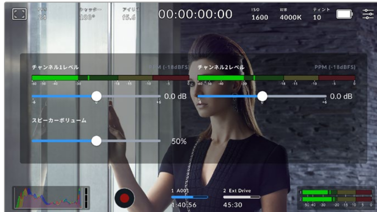
LCDタッチスクリーンでオーディオメーターをタップし、ボリュームおよびヘッドセット/スピーカー設定に簡単にアクセス
