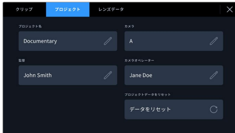
カメラの「プロジェクト (PROJECT)」スレートでプロジェクトの詳細を入力
