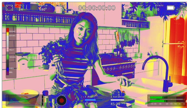
Lorsque l'image est correctement exposée, les tons chair sont représentés par des fausses couleurs vertes et roses.
