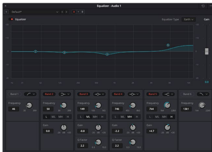
Der parametrische 6-Band-Equalizer kann auf jede Spur angewendet werden
