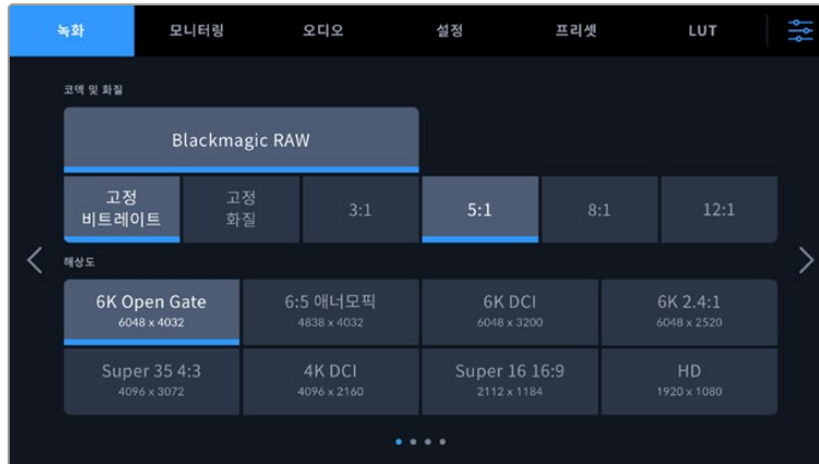
'녹화', '모니터링', '오디오', '설정', '프리셋', 'LUT' 탭을 누르면 Cinema Camera 6K의 해당 대시보드 탭으로 이동합니다.
