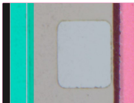
Posición correcta del borde en cinta de 8 mm. La franja superpuesta coincide con el borde de referencia de la película. La capa transparente toca correctamente el borde.
