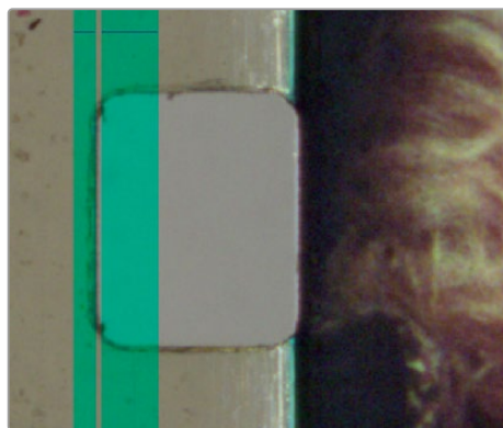
Корректная установка 8-мм пленки с перфорацией. При корректном расположении инструмент выравнивания не затрагивает содержимого изображения (прозрачная линия внутри голубой полосы соприкасается с левым краем перфорации).
