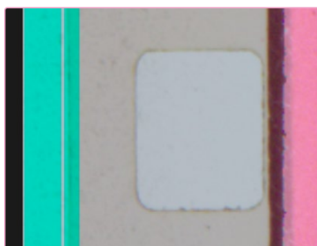
Korrekte Ausrichtung auf den Rand von 8mm-Film. Das Overlay ist korrekt auf den Rand des Referenzfilms ausgerichtet. Das transparente Overlay liegt korrekt am Rand des Referenzfilms an.
