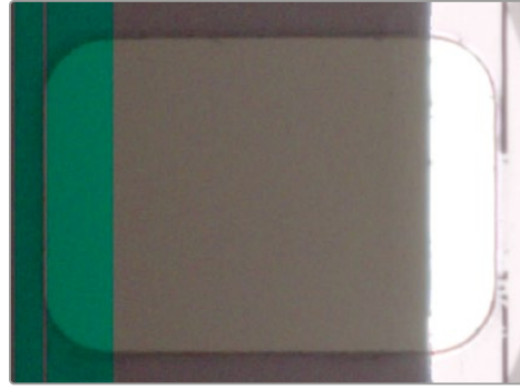
Doğru 16mm perforasyon ayarı. Sabitleme katmanı için varsayılan hizalama konumu, perforasyonun sol kenarıdır, çünkü görüntünün içeriğinden etkilenmez. Sabitleme katmanındaki şeffaf şerit, perforasyonun kenarına doğru bir şekilde temas ediyor.
