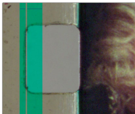
Prawidłowe ustawienie perforacji 8 mm. W przypadku nakładki stabilizującej domyślną pozycją wyrównania jest lewa krawędź perforacji, ponieważ zawartość obrazu nie ma na nią wpływu. Przezroczysty pasek w nakładce stabilizującej styka się prawidłowo z krawędzią perforacji.
