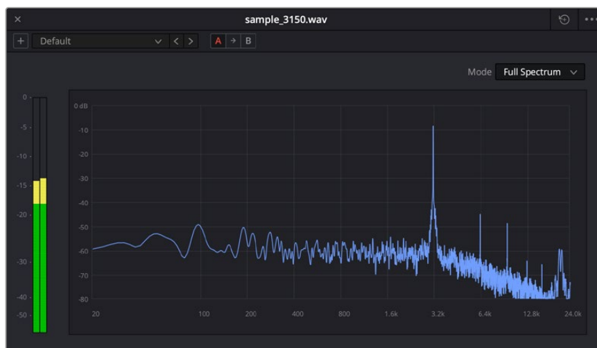
Пример трека с частотным анализом 3,15 кГц (детонация)
