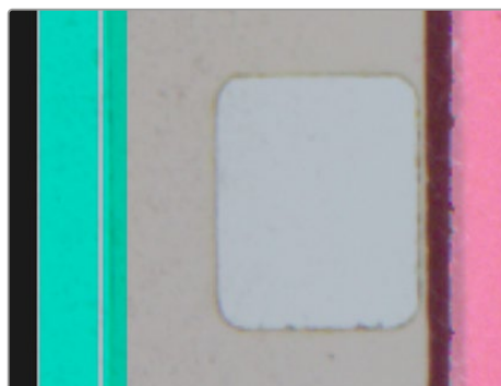
Корректная установка края 8-мм пленки. Голубая полоса совмещена с краем пленки и касается его корректным образом.
