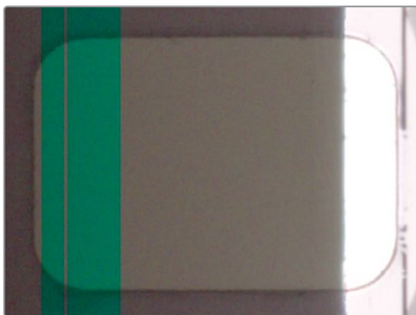
不適切にセットアップされた16mmパーフォレーション。オーバーレイがパーフォレーションのエッジに沿っていません。16mm用HDRスキッドプレートを取り付けると、スタビライズオーバーレイは、自動的にパーフォレーションの反対側に沿うように配置されるため、フィルムのイメージに影響を与えず、また横方向のスタビライズも向上します。HDRではない16mmスキッドプレートを使用している場合、35mmスキッドプレートと同様に機能します。
