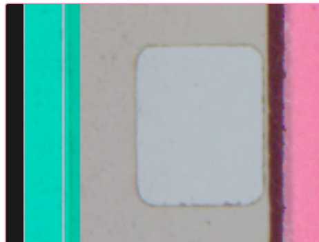
올바른 8mm 필름 가장자리 셋업. 오버레이가 필름 레퍼런스 가장자리에 정렬되어 있습니다. 투명한 오버레이가 필름 레퍼런스 가장자리에 제대로 맞닿아 있습니다.
