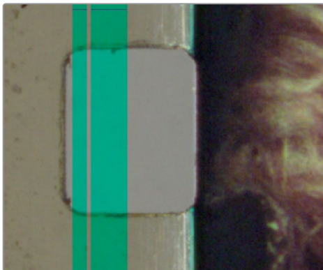
不適切にセットアップされた8mmパーフォレーション。オーバーレイがパーフォレーションのエッジに沿っていません。
