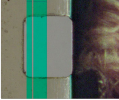
Yanlış 8mm perforasyon ayarı. Katman, film üzerindeki perforasyonun kenarıyla hizalı değil.
