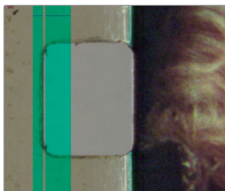
Korrekte Einstellung für die 8mm-Perforation. Die für das Stabilisierungs-Overlay standardmäßige Ausrichtung ist die linke Perforationskante, da diese nicht vom Bildinhalt beeinflusst wird. Die transparente Linie im Stabilisierungs-Overlay liegt korrekt an der Perforationskante an
