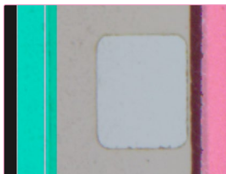
Posizionamento corretto del bordo della pellicola 8mm. L'overlay è allineato con il bordo della pellicola di riferimento. La trasparenza in sovrapposizione tocca correttamente il bordo della pellicola di riferimento
