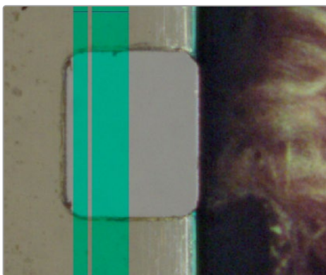
Ошибка установки 8-мм пленки с перфорацией. Голубая полоса не совмещена с краем перфорации.
