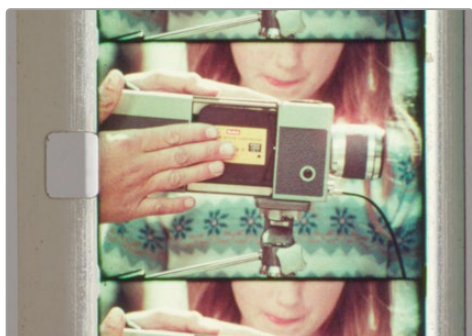
Неправильне встановлення: стулки апертури розташовані надто широко, тому з обох боків зображення з'являються світлі смуги
