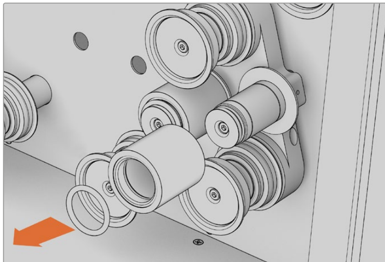
Щоб очистити ролик для видалення пилу, зніміть кільцеву прокладку, а потім стягніть ролик
