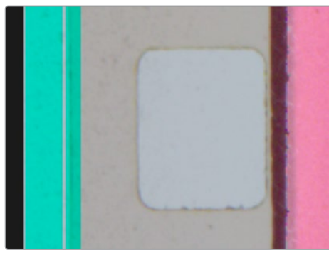
適切にセットアップされた8mmフィルムのエッジ。オーバーレイがフィルムのエッジに沿っています。水色のラインのスタビライズオーバーレイが、適切にフィルムのリファレンスエッジに触れています。
