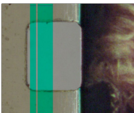
Posición incorrecta de las perforaciones en cinta de 8 mm. Como se puede apreciar en la imagen, el borde de la franja verde no coincide con el de la perforación.
