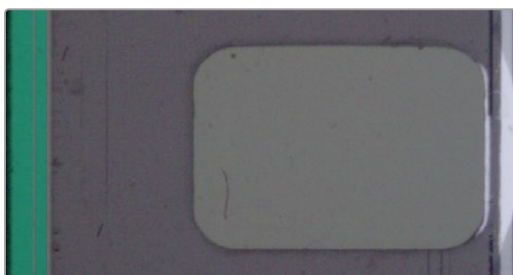
Nieprawidłowe ustawienie krawędzi taśmy filmowej 16 mm. Nakładka nie jest wyrównana do krawędzi taśmy filmowej.
