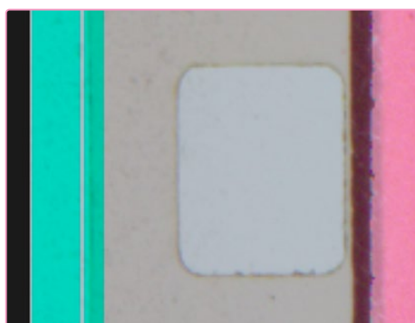
正确的8mm胶片边缘设置。叠加显示位置与胶片基准边对齐。透明叠加部分和胶片基准边准确接触。
