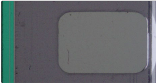
Yanlış 16mm film kenarı ayarı. Katman, filmin referans kenarı ile hizalı değil.
