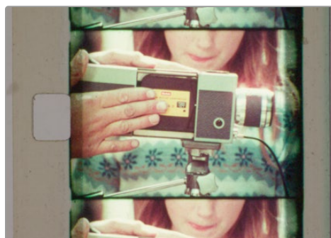
Неправильне встановлення: стулки апертури розташовані надто вузько, тому з обох боків зображення з'являються темні смуги
