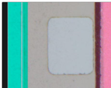
Prawidłowe ustawienie 8 mm. W przypadku nakładki stabilizującej przezroczysty pasek w nakładce znajduje się w obszarze dolnym taśmy filmowej.
