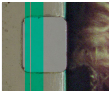
Nieprawidłowe ustawienie perforacji 8 mm. Nakładka nie jest wyrównana do krawędzi perforacji.
