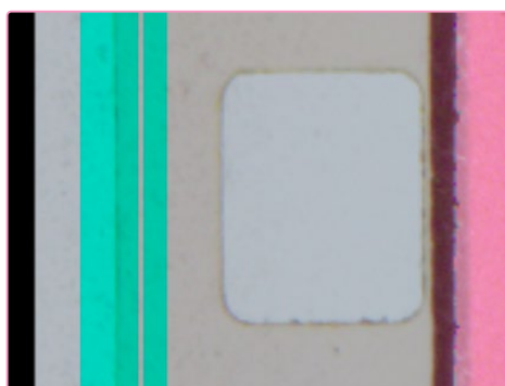
错误的8mm胶片边缘设置。叠加显示位置没有与胶片基准边对齐。
