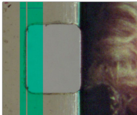
올바른 8mm 퍼포레이션 셋업. 안정화 오버레이를 위해 기본 정렬 위치가 이미지 콘텐츠에 영향을 받지 않는 퍼포레이션 왼쪽 가장자리로 설정됩니다. 이미지 안정화 오버레이의 투명 스트립이 퍼포레이션 가장자리에 제대로 맞닿아 있습니다.
