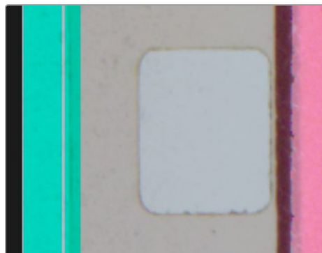
Posición correcta (8 mm). La línea transparente en la franja verde superpuesta está dentro del área de la base de la cinta.
