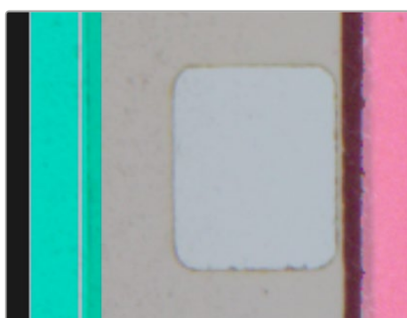
Configuração correta da borda do filme de 8 mm. A sobreposição está alinhada com a borda do filme. A sobreposição transparente encosta corretamente na borda de referência do filme.
