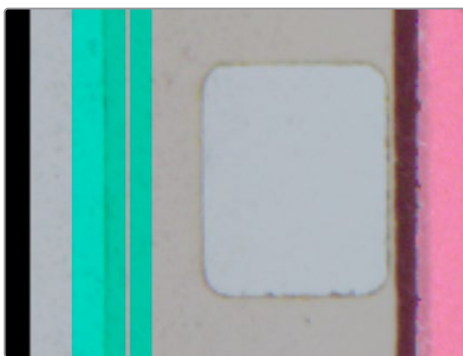
不適切にセットアップされた8mmフィルムのエッジ。オーバーレイがフィルムのリファレンスエッジに沿っていません。
