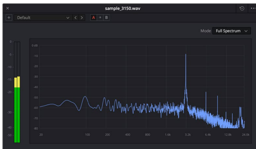
Приклад аудіодоріжки з частотним аналізом 3,15 кГц (детонація)
