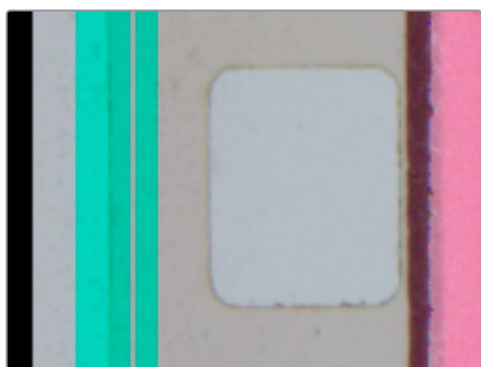
错误的8mm设置。叠加显示位置没有与胶片的边缘对齐。
