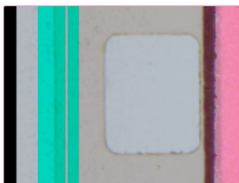
Inkorrekte Ausrichtung auf den Rand von 8mm Film. Das Overlay ist nicht korrekt auf den Rand des Referenzfilms ausgerichtet.
