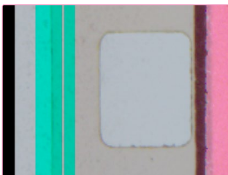
Posizionamento errato del bordo della pellicola 8mm. L'overlay non è allineato con il bordo della pellicola di riferimento.
