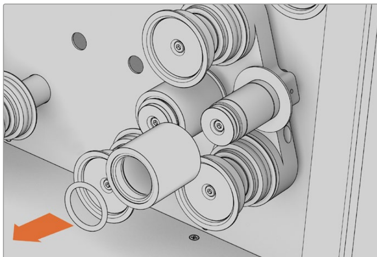
Чтобы очистить валик, снимите кольцевую прокладку с края стержня и извлеките валик
