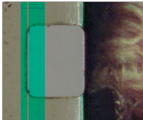
適切にセットアップされた8mmパーフォレーション。スタビライズオーバーレイは、自動的にパーフォレーションの左端に沿うように配置されます。これは、イメージの内容による影響を受けません。水色のラインのスタビライズオーバーレイが、適切にパーフォレーションのエッジに触れています。
