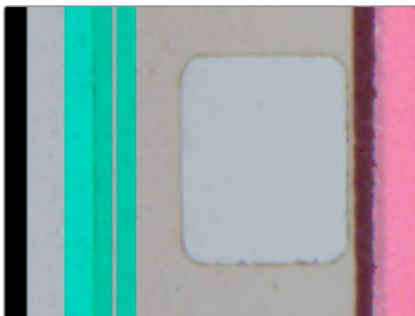
Installation incorrecte du bord du film 8mm. La bande n'est pas alignée avec le bord du film de référence.
