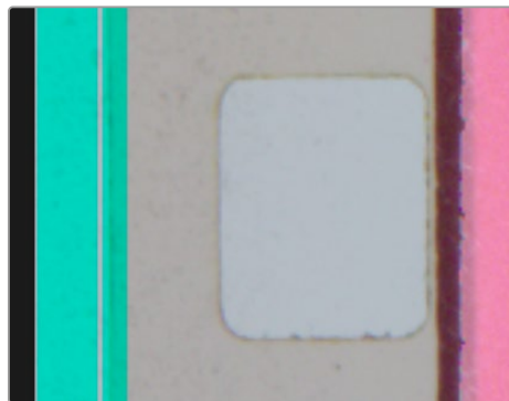
Korrekte 8mm-Einstellung. Beim Stabilisierungs-Overlay liegt der durchsichtige Streifen im Overlay innerhalb des Filmträgerbereichs
