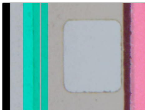
Nieprawidłowe ustawienie krawędzi taśmy filmowej 8 mm. Nakładka nie jest wyrównana do referencyjnej krawędzi taśmy filmowej.
