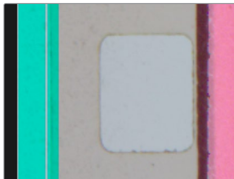
Installation correcte du bord du film 8mm. La bande est alignée avec le bord du film de référence. La bande transparente touche le bord du film de référence correctement.
