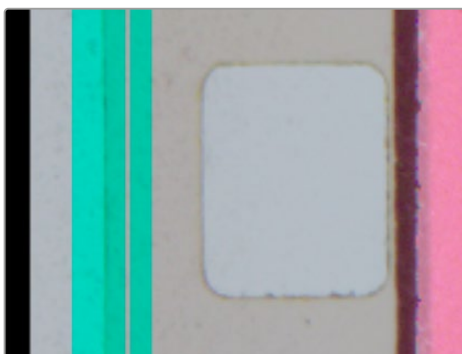
Ошибка установки края 8-мм пленки. Голубая полоса не совмещена с краем пленки.
