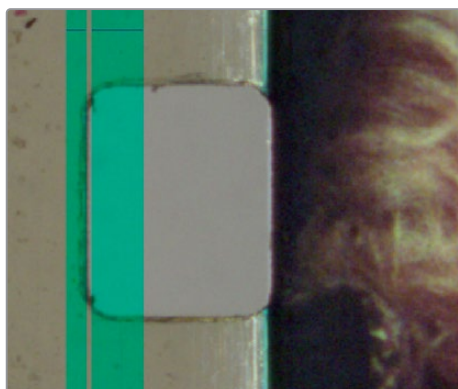
正确的8mm齿孔设置。稳定叠加显示的默认对齐位置为齿孔左侧边缘，因为这个位置不会受到图像内容的影响。稳定叠加显示中的透明细线准确地紧贴齿孔边缘。
