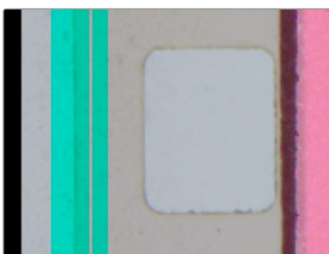
Configuração incorreta da borda do filme de 8 mm. A sobreposição não está alinhada com a borda de referência do filme.
