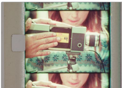
조리개 셔터가 필름의 비활성화된 이미지 영역에 맞춰 제대로 조정된 올바른 셋업.
