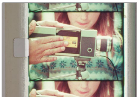
Nieprawidłowa konfiguracja pokazuje, że maskownice są ustawione zbyt szeroko, co skutkuje jasnymi obszarami po obu stronach obrazu.
