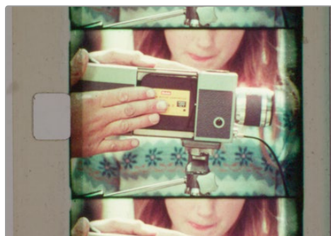
Некорректная установка: створки апертуры расположены слишком узко, поэтому по обе стороны изображения появляются темные области
