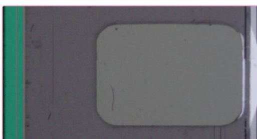
错误的16mm胶片边缘设置。叠加显示位置没有与胶片基准边对齐。
