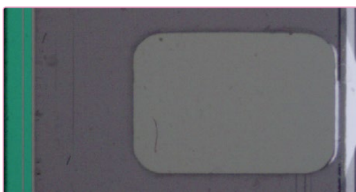
Inkorrekte Ausrichtung auf den Rand von 16mm-Film. Das Overlay ist nicht korrekt auf den Referenzfilmrand ausgerichtet
