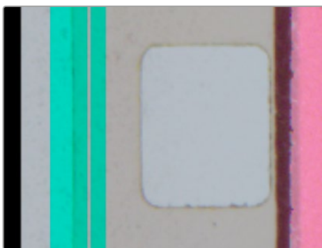
Неправильне розташування краю 8-мм плівки. Прозора лінія всередині блакитної смуги не вирівняна з краєм плівки.
