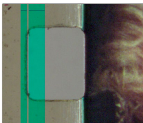
Configuração correta da perfuração de 8 mm. Para a sobreposição de estabilização, a posição padrão de alinhamento é na borda esquerda da perfuração, já que ela não é afetada pelo conteúdo da imagem. A faixa transparente na sobreposição de estabilização toca na borda da perfuração corretamente.
