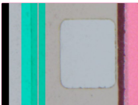
Posición incorrecta del borde en cinta de 8 mm. La franja superpuesta no coincide con el borde de referencia de la película.
