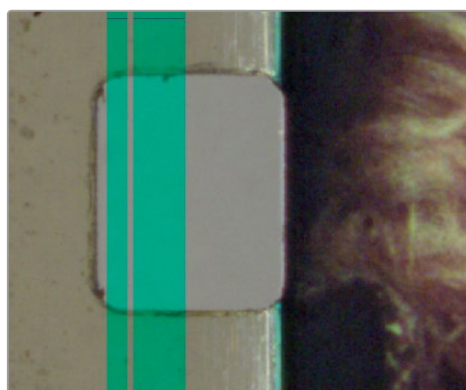
Inkorrekte Einstellung für die 8mm-Perforation. Das Overlay ist nicht korrekt auf die Perforationskante ausgerichtet
