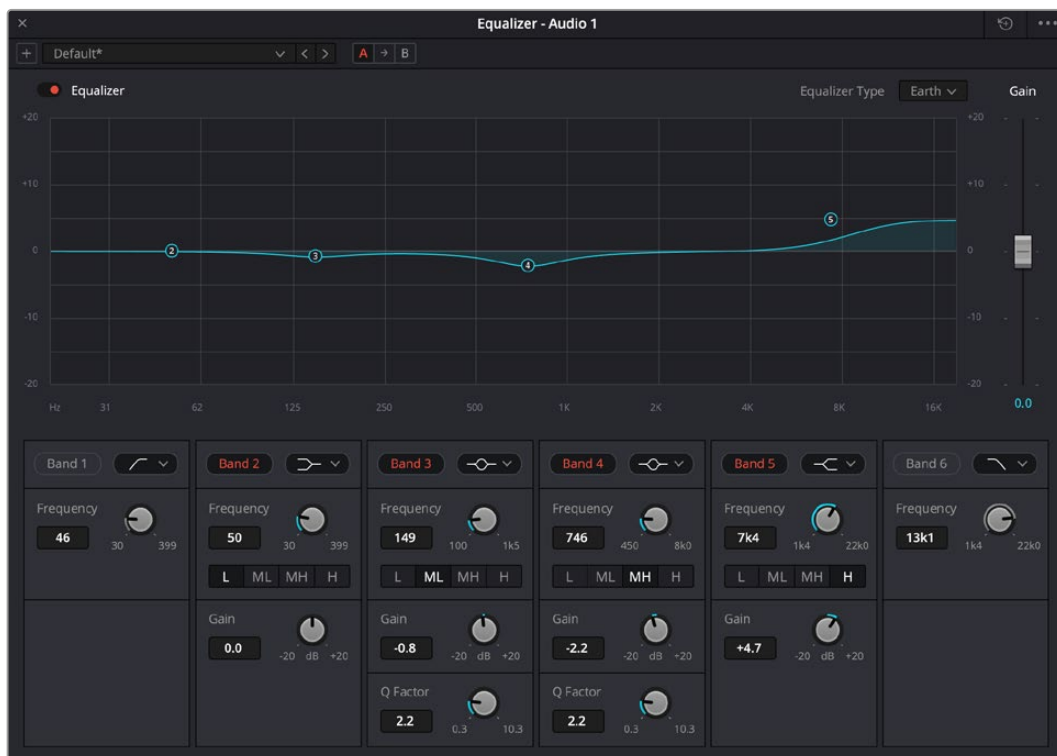
A seção EQ no painel do mixer indicando que uma curva EQ foi aplicada à trilha 1.
