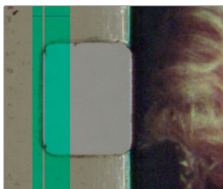
Posición correcta de las perforaciones en cinta de 8 mm. El borde de la franja de estabilización debe coincidir con el borde izquierdo de la perforación, a fin de evitar que el contenido de la imagen interfiera en el proceso. La banda transparente toca el borde de la perforación correctamente.
