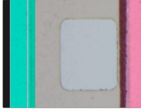
Doğru 8mm film konumu. Sabitleme katmanı için katmandaki şeffaf şerit, film taban alanı dahilindedir.
