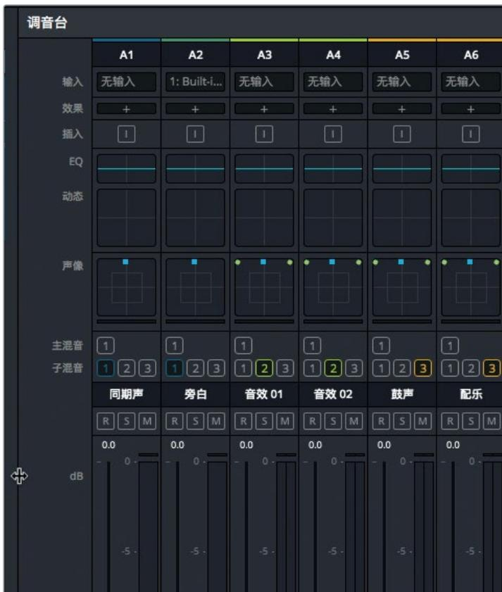
“调音台”面板包括每个时间线轨道的通道条，以及每个子混通道条和一个主音频通道条。每个通道条都会使用您为轨道和子混所指派的颜色加以标注。使用检查器时，您可以调整单个片段的音量，但是调音台中的推子操作能应用到整条轨道，或者使用子混推子应用到群组轨道。
