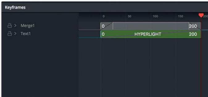
虽然关键帧轨道层层相叠,但堆叠轨道之间的上下顺序不会影响合成操作。轨道只会影响片段何时开始、何时结束,以及它们所包含的关键帧。
