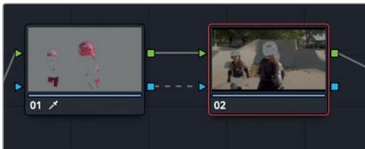
节点图中就会出现另一个节点。和您之前创建的那些节点一样，这个新的节点将通过表示 RGB 输入/输出的绿色小方块和其余节点共用连接。但是这一次，您会看到一个新的连接：表示键输入/输出的蓝色三角形图标。键就是您使用限定器工具所隔离出来的那部分图像。当您创建外部节点时，它会接收来自上一个节点的键信号，并且自动将其反转。
