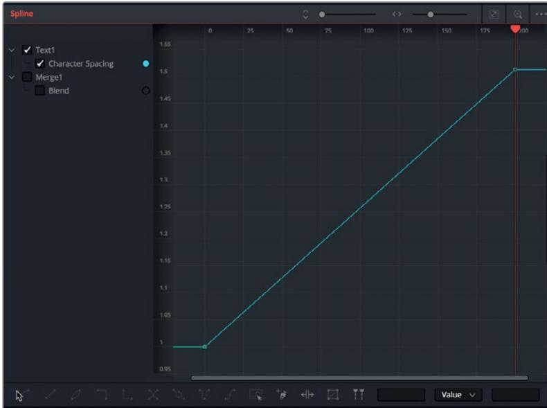
标题字符间距的动画样条线会显示在样条线编辑器当中。起始关键帧在左下角, 结束关键帧在右上角。两个关键帧之间的直线代表线性动画, 也就是该动画的持续度和稳定率。为了创建一个更加自然的动画, 您可以在这两个关键帧之间进行平滑处理。
