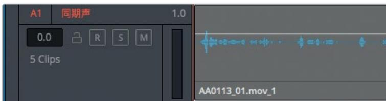
但片段本身并没有被修改。如果您将其中一个片段编辑或复制到立体声轨道上，依然会出现两个声道。这是因为单声道轨道可以只包含一个声道，当立体声片段被编辑到单声道轨道上时，会默认使用左声道（也就是在时间线上位于上方的那个声道）。由于这些片段上的两个声道是完全一样的，因此转换轨道是将所有片段变成单声道的最快方法。
