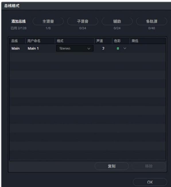
在“总线格式”窗口中，您可将轨道分配到四种总线中的一种。子混音就是其中一种类型。这一窗口目前包括了名为“Main 1”的默认主混音总线，也就是这个项目的立体声音频输出。
