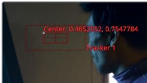
检视器中的跟踪器含有两个方框。内部的方框用来识别高对比度图案从而进行跟踪。您可以点住这个方框的左上角进行拖动来放置其位置。方框的放置位置正确与否，将决定跟踪操作是否成功。您需要找到镜头中的某个部分，这个部分除了手持式摄影机的移动之外没有任何运动。这就意味着不能选择画面中的男演员，因为他的手和头发发生了移动。因此，您需要在舷窗边缘选择一个界限清晰的位置。
