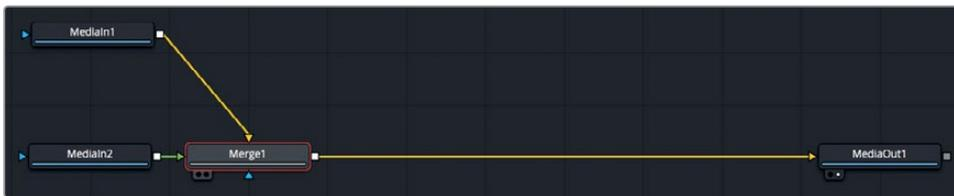
在Fusion页面中，节点编辑器可将来自V1轨道的片段显示为“MediaIn1”节点，将来自V2轨道的片段显示为“MediaIn2”节点。这两个片段会在合并节点中进行结合，将“MediaIn1”的输出端作为背景使用，将“MediaIn2”的输出端作为前景使用。为了便于区分每个节点所对应的片段，请将它们重命名。
