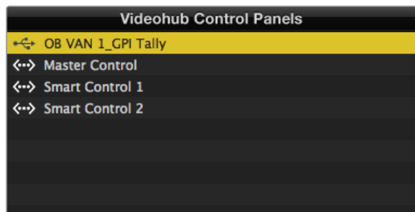
Ein via USB angeschlossenes GPI and Tally Interface
