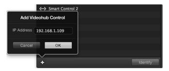
デバイス追加ボタン「+」を押して、追加したいGPI and Tally Interface のIPアドレスを入力します。「Identify」ボタンを押すと、選択したGPI and Tally InterfaceのLEDが点灯します。
