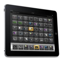
在iPad上,一个Videohub按钮屏幕最多可显示40个源和8个目标。在iPad上左右翻页,或点按左右提示圆点在不同按钮屏幕之间移动,还能显示更多源和目标。
