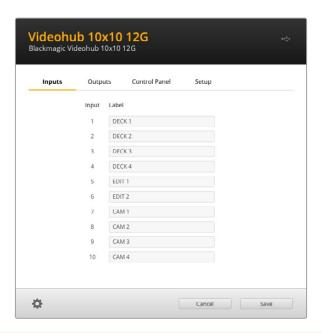
**ПРИМІТКА.** На сервері IP Videohub ярлики портів неможливо змінити, так як їхні назви походять від під'єднаного відеообладнання. Ці ярлики зберігаються на підключеному комутаторі Videohub і відображаються також на інших панелях керування в мережі.
