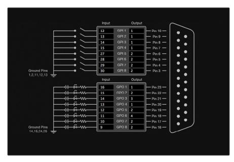
在图表内点击来更改GPI交叉点切换和Tally的输入和输出
