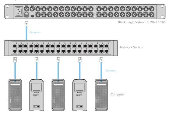
**UWAGA** Informacje na temat podłączania sprzętowych paneli sterowania Videohub do urządzenia Videohub w sieci zawiera rozdział Videohub Hardware Panel Setup.
