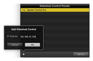
您可以通过输入IP地址来手动添加Videohub控制面板, 使其出现在Videohub Control Panel的列表中。
