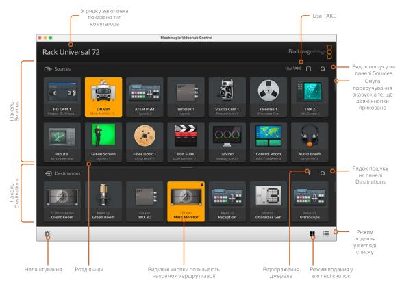
Щоб змінити розмір інтерфейсу, перетягніть краї вікна за допомогою миші. Роздільник між панелями Sources і Destinations дозволяє збільшити або зменшити одну частину екрана. Для переходу до прихованих піктограм використовують прокручування.
