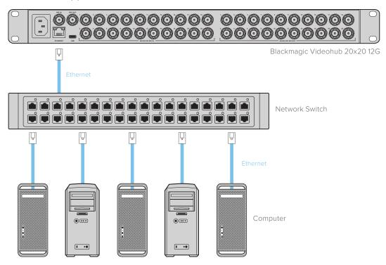
**REMARQUE** Pour obtenir des informations sur la façon de connecter des panneaux de contrôle matériels Videohub à un appareil Videohub sur le réseau, consultez la section « Videohub Hardware Panel Setup ».
