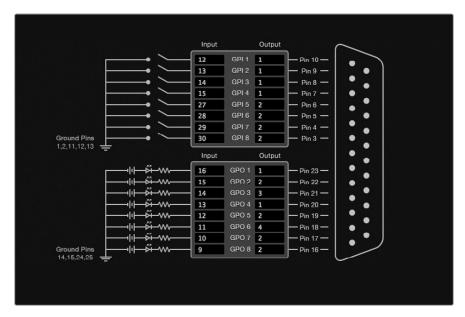
Kliknij wewnątrz schematu, aby zmienić wejścia i wyjścia dla przełączania punktów krzyżowych GPI i tally.
