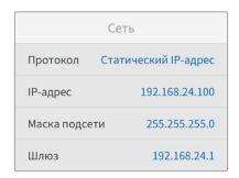
Нажмите кнопку MENU, чтобы перейти к сетевым параметрам, и задайте IP-адрес с помощью кнопки SET и круглой ручки
