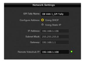
Ввод названия устройства GPI and Tally interface и настройка IP-адреса коммутатора Videohub, к которому выполняется подключение
