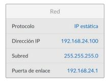
Presione el botón **MENU** para acceder a los ajustes de red y utilice el botón **SET** y el mando giratorio a fin de configurar la dirección IP.
