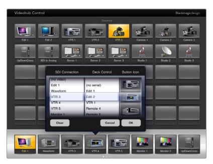
您可以在Videohub Button Setup按钮设置窗口中为该按钮设置SDI输入或输出连接、RS-422录机控制或者图标。
