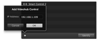
Naciśnij przycisk + (dodaj urządzenie) i wprowadź adres IP urządzenia GPI and Tally Interface, które chcesz dodać. Naciśnij przycisk **Identify**, aby włączyć diodę LED na wybranym GPI and Tally Interface.
