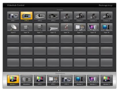
Aby zobaczyć, które źródło wideo zostało skierowane do kierunku docelowego wideo, stuknij przycisk kierunku docelowego, a przycisk powiązanego źródła wideo podświetli się
