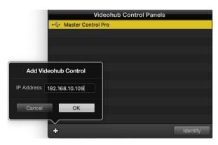
IPアドレスを入力することで「Videohub Control Panels」の リストに、Videohubコントロールパネルをマニュアルで追加可能
