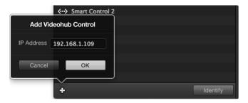
Нажмите значок плюса и введите IP-адрес добавляемого устройства GPI and Tally Interface. Нажмите кнопку Identify, чтобы на выбранной единице GPI and Tally Interface включить светодиод.
