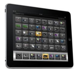
На экране планшета iPad кнопочный интерфейс приложения Videohub позволяет отображать до 40 источников и восьми приемников сигнала. Переход к кнопкам на других страницах осуществляется перелистыванием или касанием слева либо справа от строки с точками.
