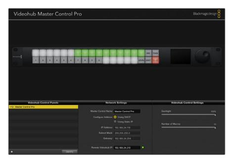
Утилита Blackmagic Videohub Hardware Panel Setup автоматически проверяет сеть на наличие в ней панелей управления Videohub
