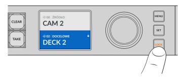
Aby uniemożliwić przełączanie ścieżek na określonym wyjściu, naciśnij przycisk **LOCK**, aby zablokować wyjście
