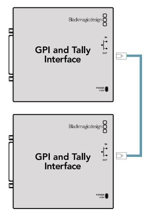
Liaison en chaîne des GPI and Tally Interface par Ethernet. Tous les appareils de la chaîne doivent être alimentés.
