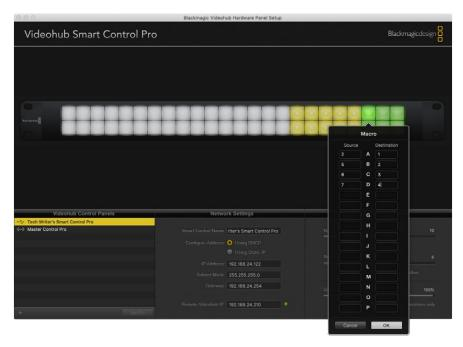
Una macro è in grado di eseguire fino a 16 percorsi di routing
