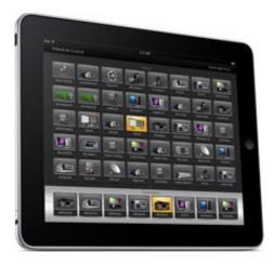
Auf einem einzelnen Videohub Pushbutton-Bildschirm lassen sich auf dem iPad bis zu 40 Quellen und 8 Ziele anzeigen. Durch Wischbewegungen nach links bzw. rechts oder durch Tippen links bzw. rechts der Punkte kann man auf einem iPad noch mehr Quellen und Ziele einblenden und durch weitere Seiten mit Pushbuttons navigieren.
