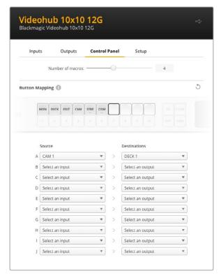
Con le macro esegui numerosi percorsi di routing in una sola volta
