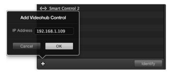
Pressione o ícone de adição e insira o endereço IP de um dispositivo GPI and Tally que você deseja adicionar. Aperte o botão "Identify" para ativar o LED na GPI and Tally Interface selecionada.
