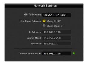
Wprowadź **GPI Tally Name** oraz adres IP urządzenia Videohub, z którym chcesz się połączyć.
