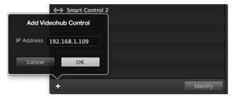
Presione el botón + para añadir otro dispositivo e ingrese la dirección IP correspondiente. Presione el botón **Identify** para identificar una unidad.
