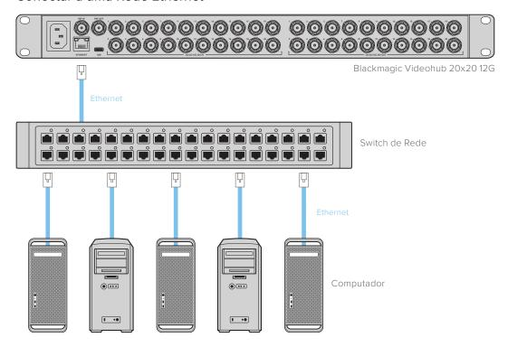
**OBSERVAÇÃO** Para obter informações sobre como conectar os painéis de controle Videohub físicos a uma unidade Videohub na rede, consulte a seção "Videohub Hardware Panel Setup".
