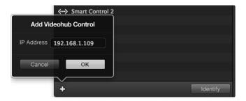
Cihaz ekleme butonu olan "+" butonuna basın ve eklemeyi istediğiniz bir GPI and Tally Interface cihazının IP adresini girin. Seçili bir GPI and Tally Interface cihazındaki LED lambasını aktif duruma getirmek için "identify" butonuna basın.
