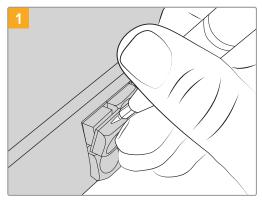
Mit einem Flachkopfschraubendreher lassen sich die Tastenkappen leicht abnehmen.
