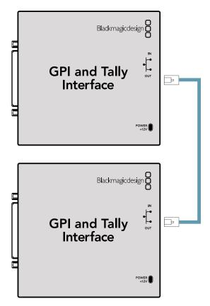
Birden fazla GPI and Tally Interface cihazını Ethernet ile birbirine zincirleme bağlama. Zincirdeki cihazların hepsine güç sağlanmalıdır.
