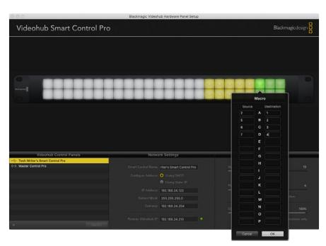
Es posible cambiar hasta 16 puntos de cruce mediante una sola macro.
