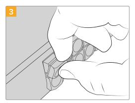
Setzen Sie die Tastenkappe mit korrekter Ausrichtung wieder in den Tastenblock ein und drücken Sie sie vorsichtig ans Gerät, bis sie einrastet.
