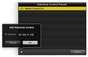
IP 주소를 사용해 Videohub Control Panel을 Videohub Control Panels 창 목록에 수동으로 추가할 수 있습니다
