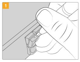
Las tapas de los botones pueden quitarse con facilidad mediante un destornillador de cabeza plana.
