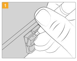
Крышки кнопок легко снять с помощью небольшой шлицевой отвертки.
