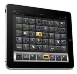
iPad'daki tek bir Videohub Pushbutton ekranında, 40 adede kadar kaynak ve 8 adet hedef görüntülenebilir. iPad ekranını sağa veya sola kaydırarak daha da fazla kaynak ve hedef görüntülenebilir veya birden fazla arayüz buton ekranı arasında dolaşmak için, ekranın alt kısmındaki bir dizi noktanın sağına veya soluna tıklanabilir.
