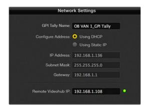
在"GPI Tally Name"栏内输入名称,并在"IP Address" 栏内输入所连接Videohub的IP地址
