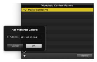
Você pode adicionar um painel de controle Videohub manualmente, pelo endereço IP, à lista "Videohub Control Panels".
