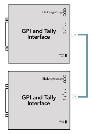
Collega a cascata diversi GPI and Tally Interface tramite ethernet. Tutte le unità devono essere collegate alla corrente
