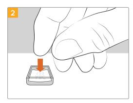
Legen Sie Ihr ausgedrucktes Etikett lose in die mit der Öffnung nach oben zeigende Tastenkappe.
