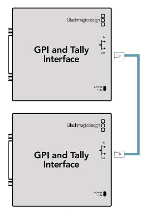
イーサネットを使用して、複数のGPI and Tally Interfaceをデイジーチェーン接続。チェーン上の全ユニットに電源が供給されている必要があります。
