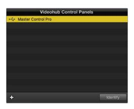
イーサネット/USB接続されているすべてのコントロール ユニットが「Videohub Control Panels」ウィンドウに リストアップされ、それぞれのアイコンが表示されます。
