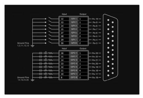
Haga clic en el diagrama para cambiar las entradas y salidas en los puntos de cruce mediante el dispositivo GPI and Tally Interface
