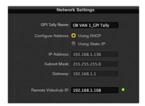
Введення назви блока GPI and Tally Interface і налаштування IP-адреси комутатора Videohub, до якого виконується підключення
