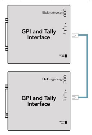
Połącz łańcuchowo wiele urządzeń GPI and Tally Interface za pomocą Ethernetu. Do każdej jednostki w łańcuchu musi być doprowadzone zasilanie.
