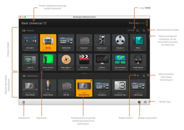
Kliknij i przeciągnij krawędzie okna, aby zmienić rozmiar Blackmagic Videohub Control i dopasować go do rozmiaru ekranu. Przeciągnij pasek rozdzielający w górę lub w dół, aby odsłonić więcej lub mniej obszarów źródłowych i docelowych, i użyj pasków przewijania, aby przewijać te obszary.
