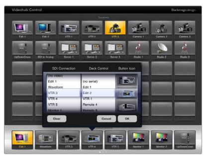
Im Videohub Button-Setup-Fenster können Sie SDI-Ein- und Ausgaben, die RS-422-Decksteuerung und die Symbole für Icons einrichten
