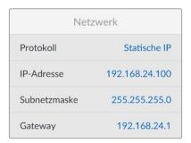
Drücken Sie die MENU-Taste, um zur Netzwerkseite zu gelangen, und stellen Sie die IP-Adresse mithilfe der SET-Taste und des Suchlaufreglers ein
