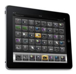
Na jednym ekranie przycisków Videohub na iPadzie można wyświetlić do 40 źródeł i 8 kierunków docelowych. Jeszcze więcej źródeł i kierunków docelowych można wyświetlić, przesuwając palcem po iPadzie w lewo lub w prawo albo stukając w lewo lub w prawo od rzędu kropek, aby poruszać się po wielu ekranach przycisków.
