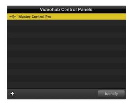
Ethernet veya USB ile bağlı kontrol cihazlarının hepsi, ilgili bir ikon ile "Videohub Control Panels" penceresinde listelenecektir
