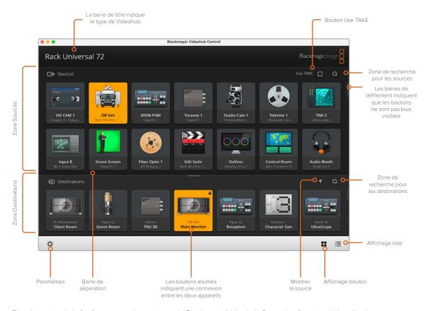
Tirez les coins de la fenêtre pour redimensionner le Blackmagic Videohub Control en fonction de la taille de votre écran. Déplacez la barre de séparation vers le haut ou vers le bas pour agrandir ou réduire les zones **Sources** et **Destinations** et utilisez les barres de défilement pour faire défiler les éléments qui s'y trouvent.
