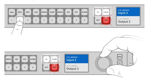
Для вибору джерела та приймача також можна використовувати поворотну ручку
