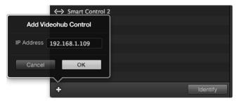
+(add device) 버튼을 누른 다음 추가하려는 GPI and Tally Interface의 IP 주소를 입력하세요. 'Identify' 버튼을 누르세요. 선택한 GPI and Tally Interface의 LED가 활성화됩니다.
