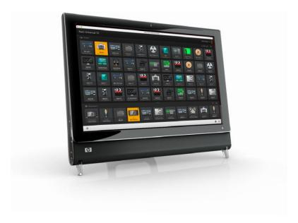
Z tego powodu zalecamy konfigurację przycisków za pomocą myszy. Po skonfigurowaniu przycisków Videohub można łatwo używać palca do wybierania oraz kierowania wejść i wyjść poprzez stukanie w przyciski Videohub.
