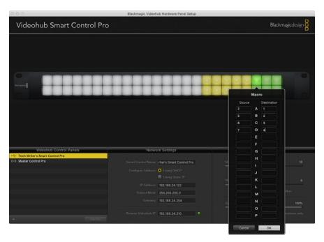
Mit einem einzigen Makro können die Signalwege für bis zu 16 Koppelpunkte geändert werden
