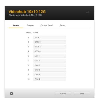
**UWAGA** Nie można edytować etykiet portów IP Videohub, gdyż są one tożsame z podłączonymi urządzeniami wideo IP. Etykiety są przechowywane na podłączonych Videohub i są widoczne na innych panelach sterowania połączonych z Twoją siecią.
