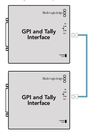
Schalten Sie mittels Ethernet mehrere GPI and Tally Interface Geräte in Reihe. Jedes einzelne in Reihe geschaltete Gerät muss mit Strom versorgt werden
