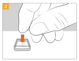
将新打印的标签放在朝上放置的透明键帽内。
