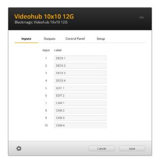
**NOT** Bir IP Videohub'daki port etiketleri bu uygulama ile değiştirilemez çünkü, bu etiketler bağlı olan IP Video cihazlarından gelir. Etiketler, bağlı Videohub cihazınıza kaydedilir ve ağınıza bağlı olan diğer kontrol panellerinde de görünürler.
