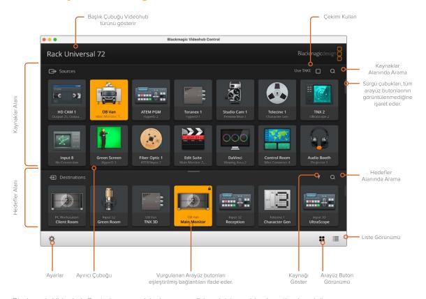
Blackmagic Videohub Control penceresini, ekranınıza sığdırmak için yeniden boyutlandırmak üzere, pencerenin kenarlarını tıklayıp sürükleyin. "Kaynak" ve "Hedef" alanlarını büyütmek veya küçültmek için Ayırıcı Çubuğu yukarı veya aşağı sürükleyin ve bu alanları kaydırmak için de Kaydırıcı Çubukları kullanın.
