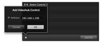
Cliquez sur le bouton + et saisissez l'adresse IP de la GPI and Tally Interface. Appuyez sur le bouton Identify pour activer le voyant LED sur l'appareil sélectionné.
