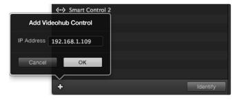
Klicken Sie zum Hinzufügen eines Geräts auf das "+"-Symbol und geben Sie die IP-Adresse des hinzuzufügenden GPI and Tally Gerätes ein. Klicken Sie auf den "Identify"-Button, um die LED des ausgewählten GPI and Tally Interface zu aktivieren
