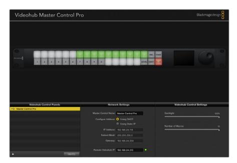
Blackmagic Videohub Hardware Panel Setup uygulaması, ağınızda bulunan Videohub kontrol panelleri bulmak için, otomatik olarak ağınızı tarar
