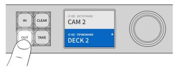
При блокировке выхода на ЖК-дисплее отображается значок замка
