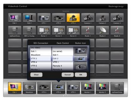
La fenêtre Videohub Button Setup vous permet de régler la source ou la destination SDI, le contrôle RS-422 et l'icône du bouton
