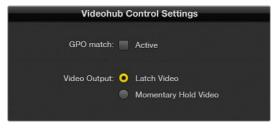
Başka bir çapraz yönlendirme seçilene kadar önizlemenizin tutulmasını istiyorsanız "Latch Video"yu seçin. Kontrol düğmesini bıraktığınızda, önizlemenin bir önceki çapraz yönlendirmeye geri dönmesini istiyorsanız "Momentary Hold Video"yu seçin.
