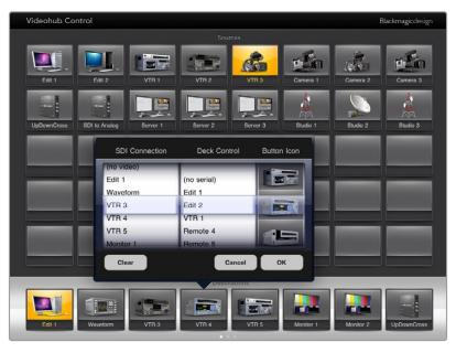
Videohub Button Setup penceresi; SDI giriş veya çıkış bağlantısını, RS-422 deck kontrolünü ve arayüz butonu için ikonu ayarlamanıza imkan tanır
