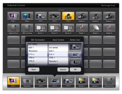
A janela de configuração de botões Videohub permite que você defina a conexão de entrada ou saída,controle de deck RS-422 e o ícone para o botão.
