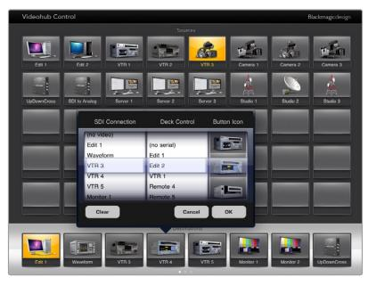
Videohub Button Setupウィンドウ。該当のプッシュボタンのSDI入出力の接続、RS-422デッキコントロール、アイコンを設定可能。
