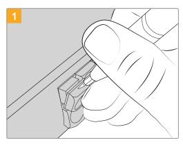
As tampas dos botões podem ser facilmente removidas usando uma pequena chave de fenda.
