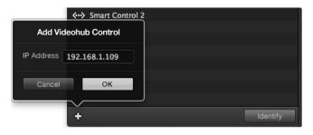
按"+"(添加设备)按钮并输入您想要添加的GPI and Tally Interface的IP地址。按"Identify"(识别)按钮激活所选GPI and Tally Interface上的LED提示灯。
