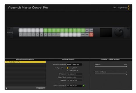
O Blackmagic Videohub Hardware Panel Setup procura por painéis de controle Videohub automaticamente na sua rede.
