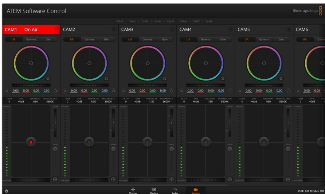
Arbeitsraum ATEM Kamerasteuerung
