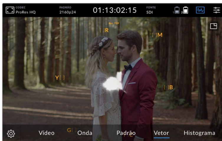
O vetorscópio exibe a o intervalo geral de saturação dentro da imagem.
