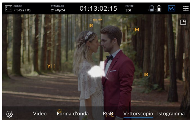
Il vettorscopio indica la tinta e la saturazione complessive dell'immagine
