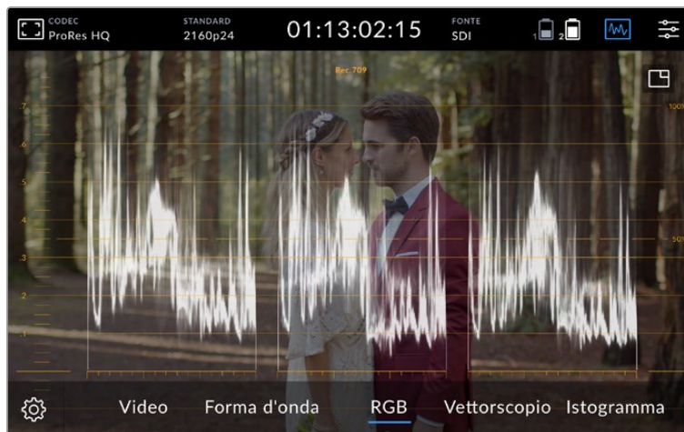
L'allineamento RGB mostra forme d'onda distinte per la luminosità dei canali rosso, verde, e blu
