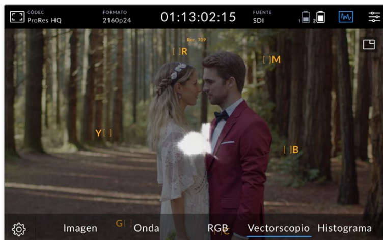
El vectorscopio mide el rango general de matiz y saturación dentro de una imagen.
