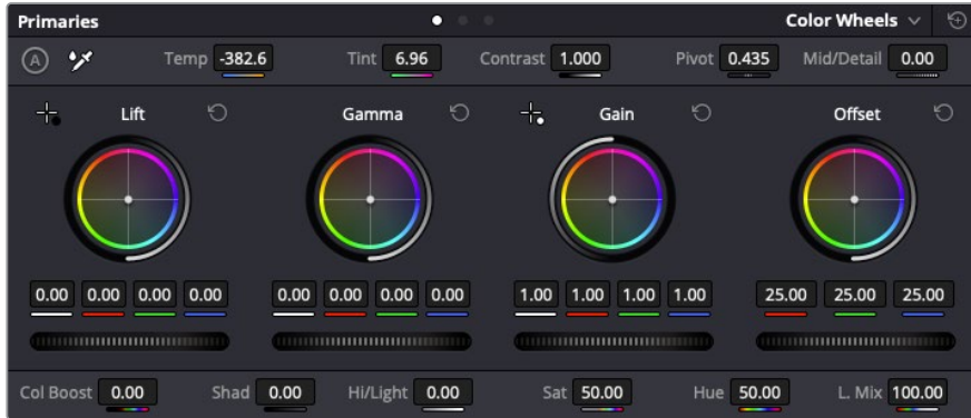
'Lift', 'gamma', 'gain' ve 'offset' renk tekerleri, kliplerinizin renk ve tonlama dengesi üzerinde tam kontrol sağlar. Her bir tonlama bölgesi için renklerin tümüne aynı ayarlamayı yapmak üzere, renk tekerlerinin altında bulunan kadranı, ileri ve geri sürükleyin.
