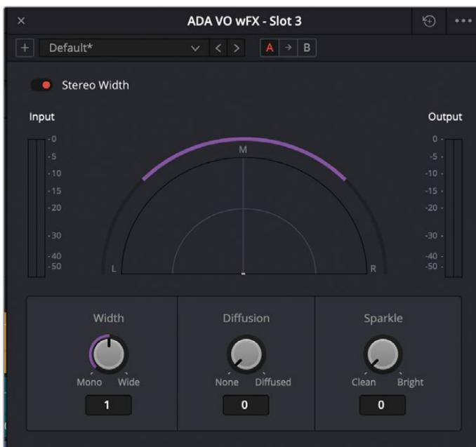
您可以对任何立体声轨道应用Stereo Width插件, 将立体声声场布局从单声道快速调整到立体声、超宽或二者之间的任何位置。“扩散”控制可添加输出信号的复杂程度, “亮色”控制可提高高频增益。
