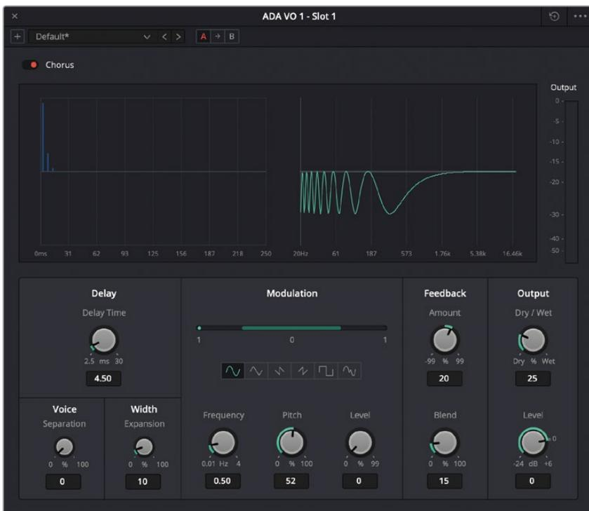
在打开的“Chorus”（合唱）对话框中，显示了一组图表：左侧是各个声音之间的时间差图表，右侧是应用了参数变化之后的信号动态图。
