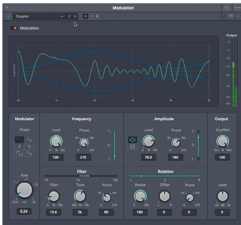
观察调制参数中的多个绿色调制显示条，可以看到“Doppler”（多普勒效果器）预设需要对这四个控制领域进行调制：频率、振幅、滤波器以及旋转。
