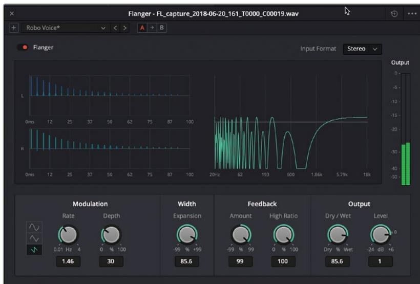
“Flanger”（镶边）窗口中设有一个动态图表，可显示不同的调制参数结果，方便您查看在原版信号上添加颤音后的效果。当前设置是使用了“Robo Voice”（机器人语音）预设的自定义版本。
