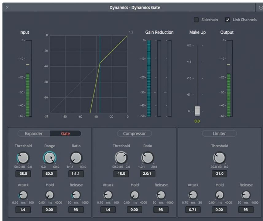
根据图表和“增益衰减”音频表显示可判断出，位于“阈值”(-35dB)以下的信号会受到最高程度的增益衰减(-60dB)。该设置对这个信号而言有些矫枉过正。
