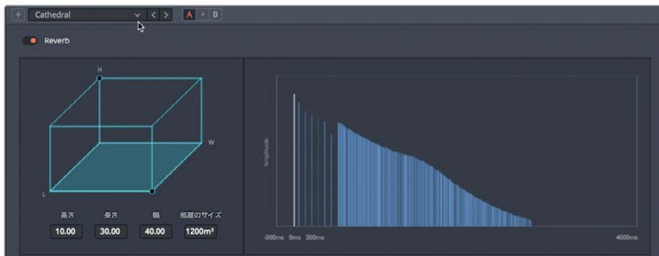
留意观察对话框左侧显示的虚拟房间大小，它和右侧图表中显示的混响拖尾长度是对应的。
