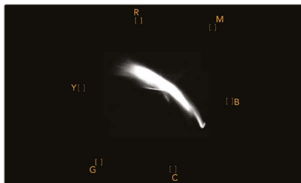
Vektorskop, das die Hauttonlinie nahe der 10-Uhr-Position anzeigt
