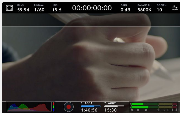
Ekran dotykowy LCD z włączonymi liniami kadru o proporcjach 2,40:1
