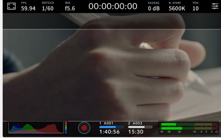
2.40:1 çerçeve kılavuzları etkinleştirilmiş dokunmatik LCD ekran
