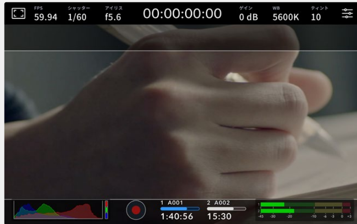
2.40:1フレームガイドを有効にしたLCDタッチスクリーン
