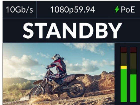
전원과 비디오가 모두 연결되면 PoE 표시 장치에 초록색 불이 들어온 다음, 비디오 이미지와 'STANDBY' 표시가 나타납니다.
