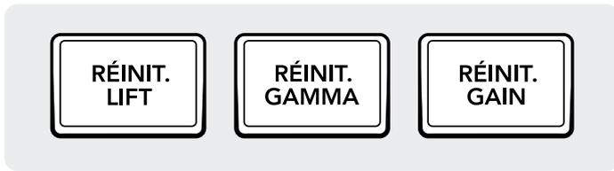
**Réinit. lift :** Cette touche réinitialise toutes les modifications RVB et de niveau effectuées par la boule de commande et la bague de gauche.
