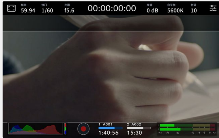
LCD触摸屏启用2.40:1帧导栏设置后的显示。
