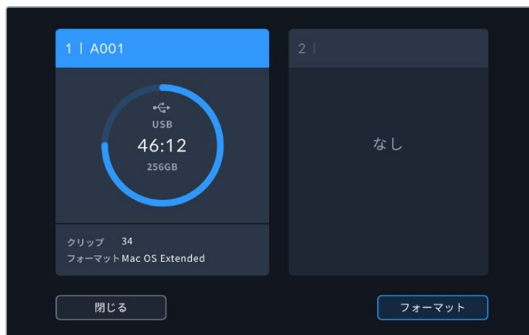
LCDタッチスクリーンのストレージインジケータをタップしてストレージ管理へアクセス
