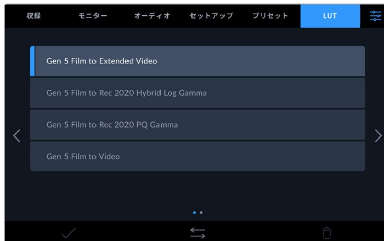
カメラのLUTタブを使って3D LUTを選択
