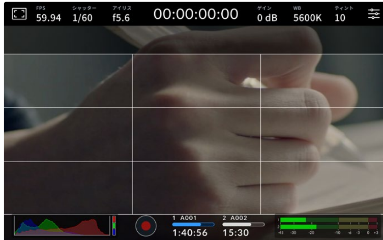
3x3グリッドのグリッドはスクリーンのフレームガイドに合わせて自動的に調整されます。
