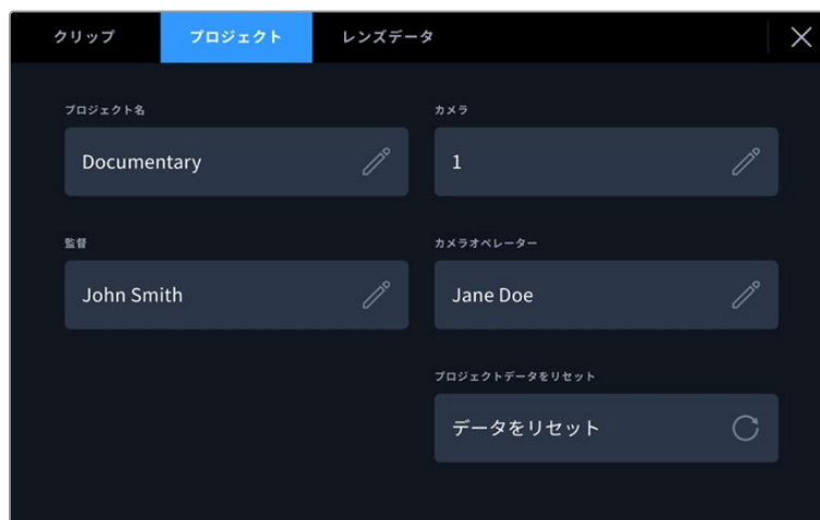
カメラの「プロジェクト (PROJECT)」スレートでプロジェクトの詳細を入力
