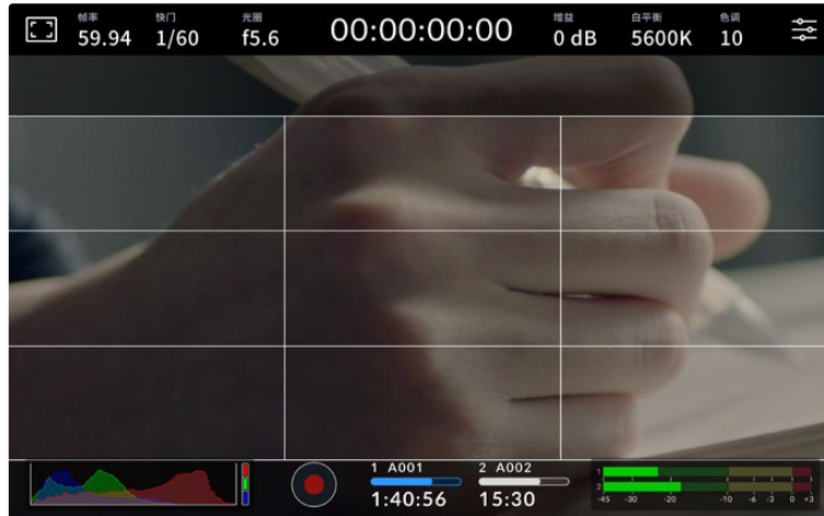
三分法网格可自动缩放以适应任意屏幕帧导航。
