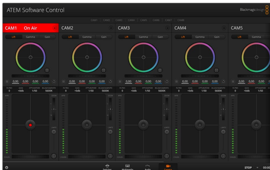
Interfaccia di controllo camera di ATEM Software Control
