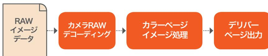
RAWのデコードは、最初に行われるイメージ処理作業であり、カラーページの他のすべての処理の前、ノードエディターのソースバーよりも前に実行されます。このことから、RAWイメージからResolveで利用できるイメージデータへの理想的な変換とは、イメージデータをその後のイメージ処理作業のために最大限に保持できる変換であることを理解することが大切です。32-bit浮動小数点の精度を持つResolveのイメージ処理パイプラインは、変換したすべてのRAWデータを極めて高い色忠実度で保持します。グレーディングを開始するのに最適なベースを作成する際には、「Camera RAW」パネルのパラメーターが有効です。
