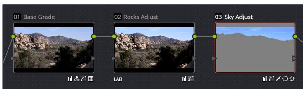
ノードに表示されたラベルとバッジで、各ノードで適用している機能を確認できます。
