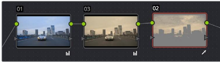
ノード2の最適なイメージデータを使用した場合と比較して、ノード3のキーは品質が落ちています。
