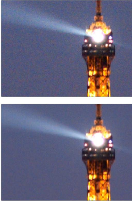
ビフォー(上)&アフター(下)。時間的ノイズ除去を使用してイメージ内の動きのない部分のノイズを低減
