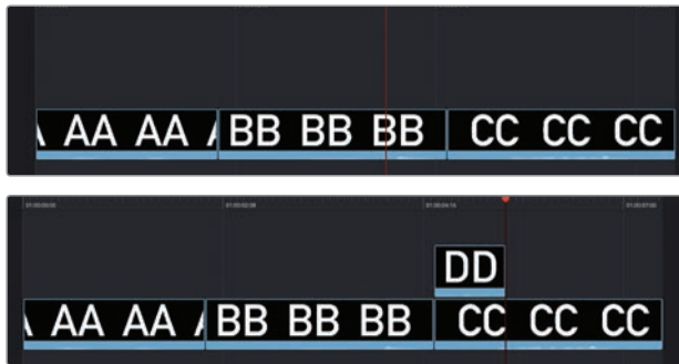
(上) クローズアップ編集前、(下) クリップDDをクローズアップ編集してタイムラインの最上位トラックに配置
