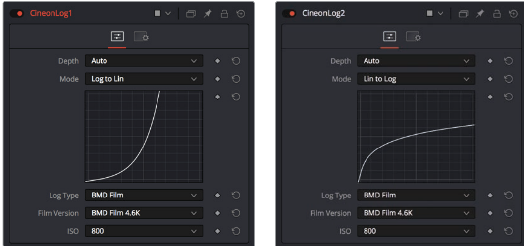
(左) 1番目のCineonLogノードによるログからリニア変換、 (右) 2番目のCineonLogノードによるリニアからログ変換
