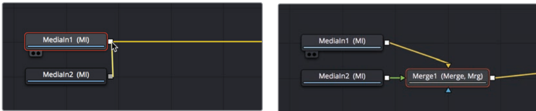
(左) 接続されていないノードの接続を別ノードの出力にドラッグする、 (右) ノードをドロップすることで作成されるマージノード合成
