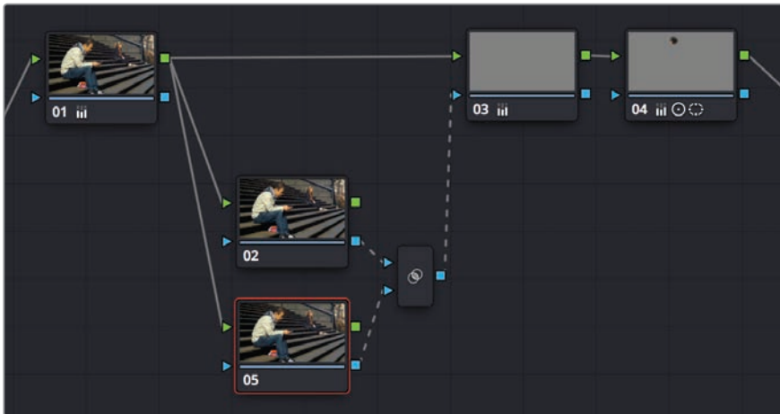
ノードツリーで2つのキーを結合する場合のセットアップ
