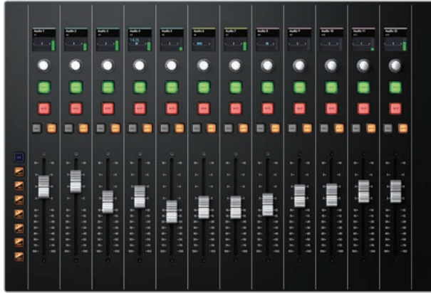
Fairlightオーディオコンソールフェーダーコントロール
