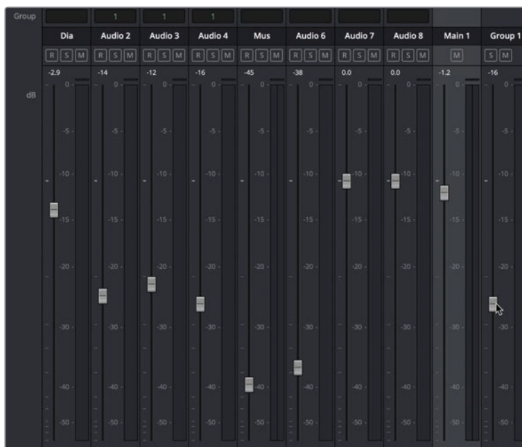
Group 1フェーダーを調節すると、そのグループに割り当てられている Audio 1、3、4のフェーダーも調節されます。
