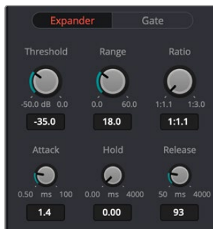
ダイナミクスウィンドウのFairlight「エクspander/ゲート」パラメーター
