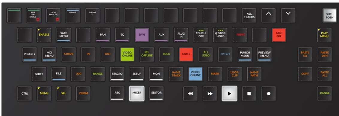
ジョグホイールの近くに「Mix On」と「Mix Automation」のキーが配置された代替Mixerツールセット
