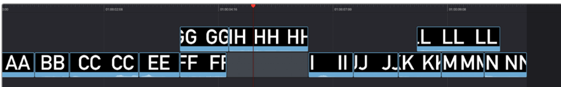
クリップDDが削除され、トラック1のクリップEEからNNまでが左に移動；合成クリップは同期しているため一緒に移動
