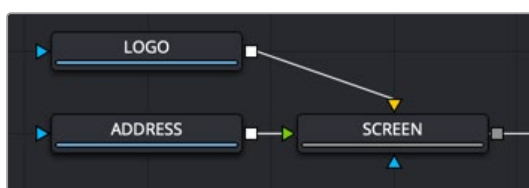
Photoshop PSDファイルの2つのレイヤーが読み込まれ、画面適用モードに設定されたMergeノードに接続されます。
