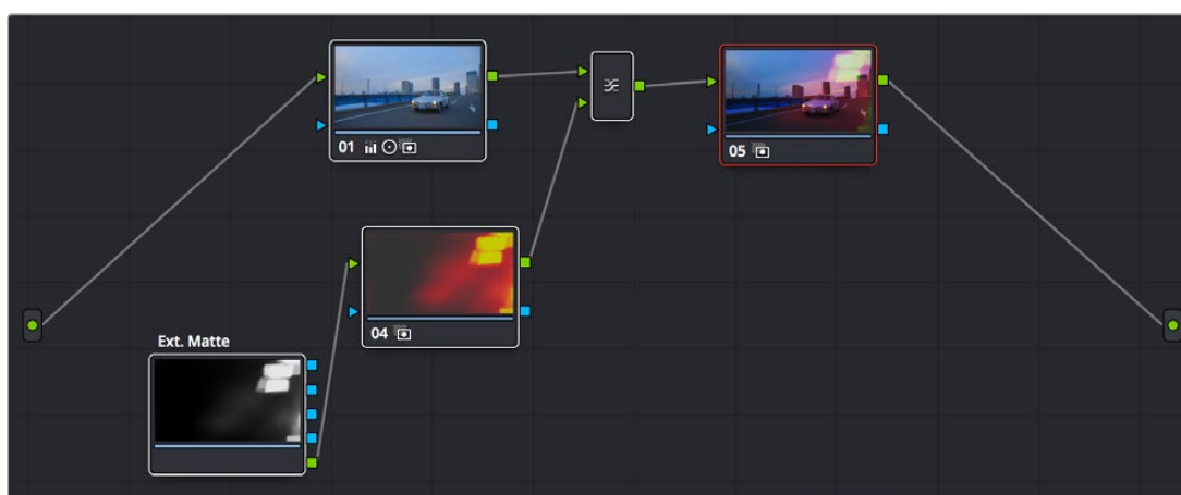
外部マットノードのRGB出力を、レイヤーミキサーに接続されたノードの入力に接続。これで、合成モードでグレードとブレンドできます。
