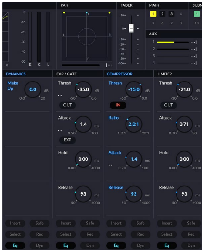
「コンプレッサー」コントロールセットは、オプションのHDMIモニターで視覚的にフィードバックされます。フォーカスモードのダイナミクスパラメーターは、すべてHDMIデータ画面の1つのセクションにまとめられています。アクティブなダイナミクスコントロールは青でハイライトされています。
