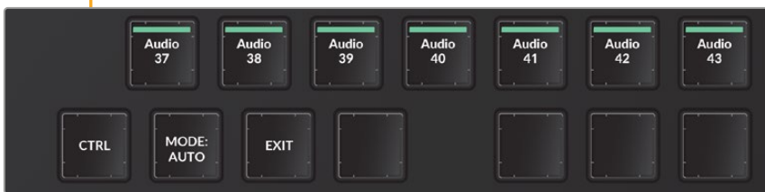
ピクチャーキーボードの左下にあるオートフェーダーバンクマッピングのアクションキー
