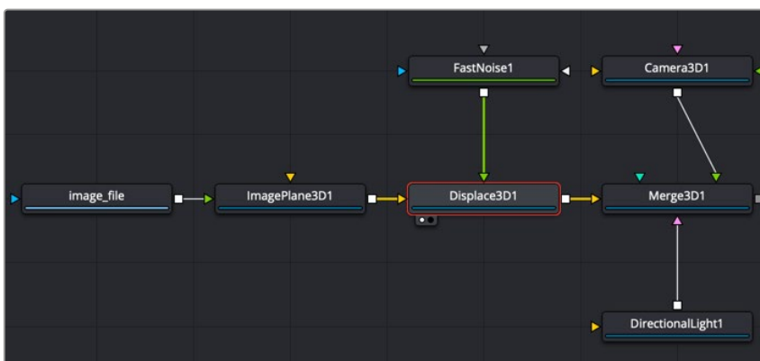
Image Plane 3D上の画像がFast Noiseノードによって変位する
