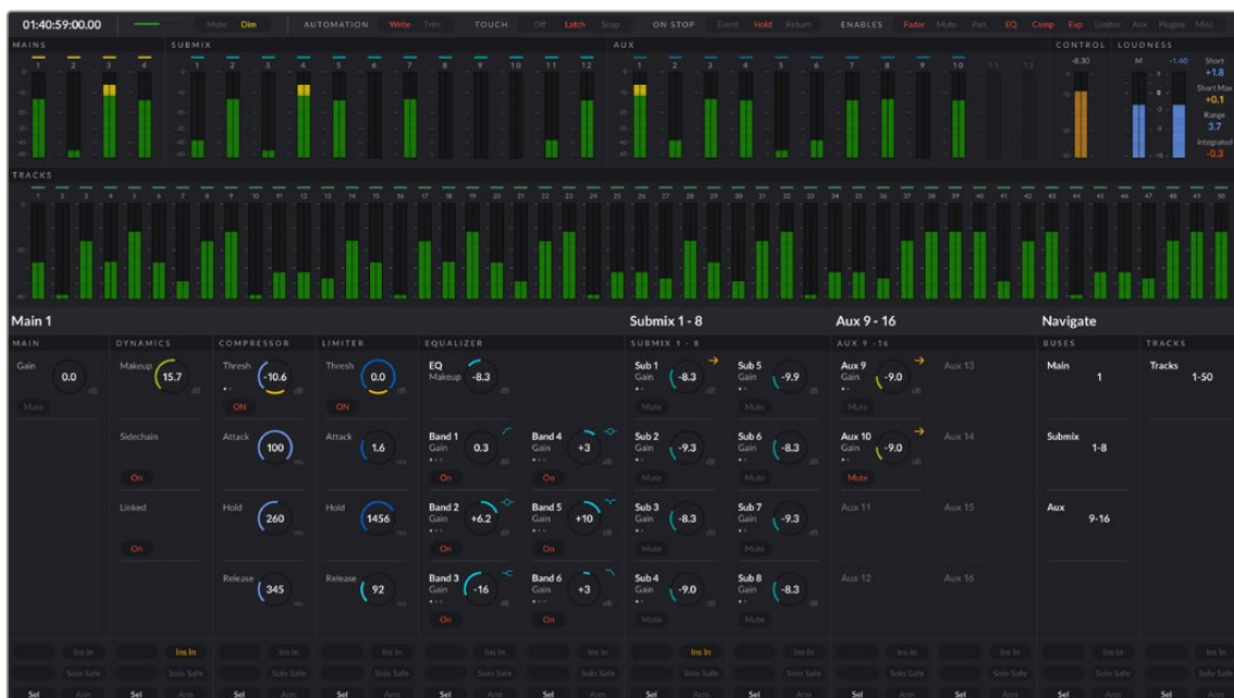
マスターモードを表示するFairlightコンソールの液晶モニター
