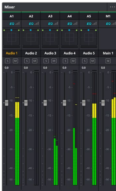
オーディオミキサー。4つのチャンネルストリップは、タイムラインの4つのトラックに対応しています。
