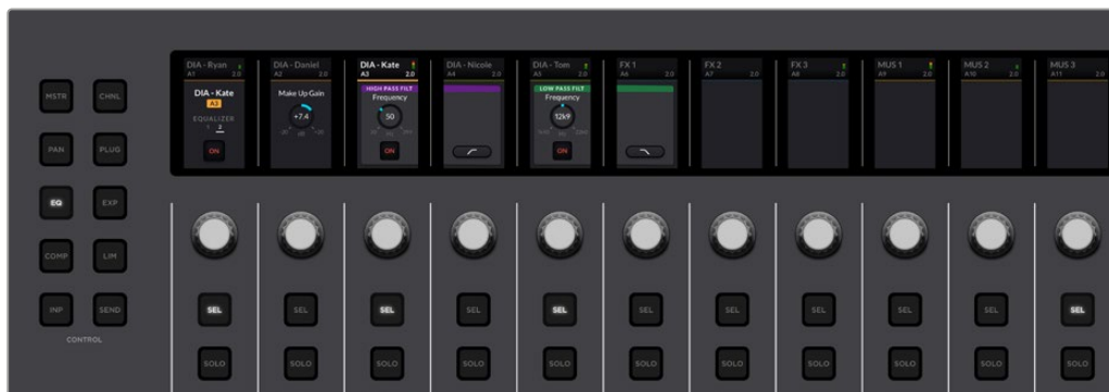
EQコントロールセットページ2 (バンド1と6のフィルター用コントロール付き)
