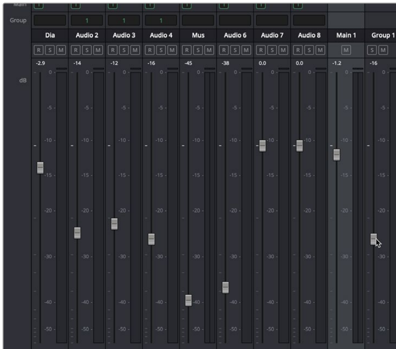
グループ1のフェーダーを調整すると、そのグループにアサインされているオーディオ1、3、4のフェーダーも調整される
