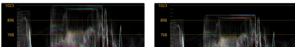
(左) デフォルトのデータレベルで表示された波形スコープ、 (右) 同じ波形をビデオレベルスコープをONにして表示したもの
