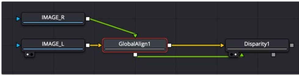
左右の目のズレを手動で補正するための全体のアラインメントノード
