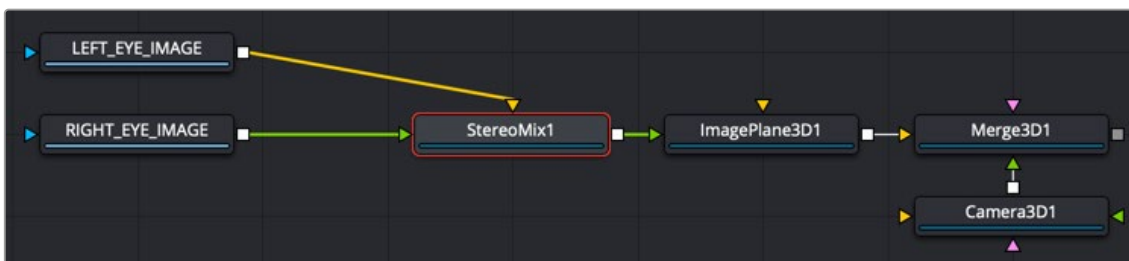
左と右の画像を1つのステレオ素材に合成するためのStereo Mixノード
