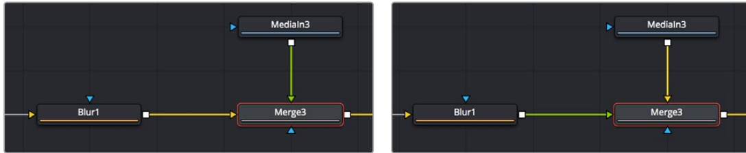
ノード入力の入れ替え前 (左)、ノード入力の入れ替え後。接続ラインは移動しないが色が変わる (右)
