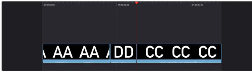
再生ヘッドのクリップ全体 (BB) と後続クリップ (DD) を差し替えるリップル上書き
