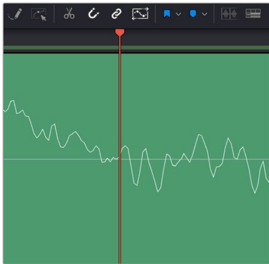
波形インジケータの中心線がゼロクロッシングです。
