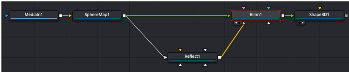
ディフューズとスペキュラのカラーマテリアルを接続したBlinnシェーダー
