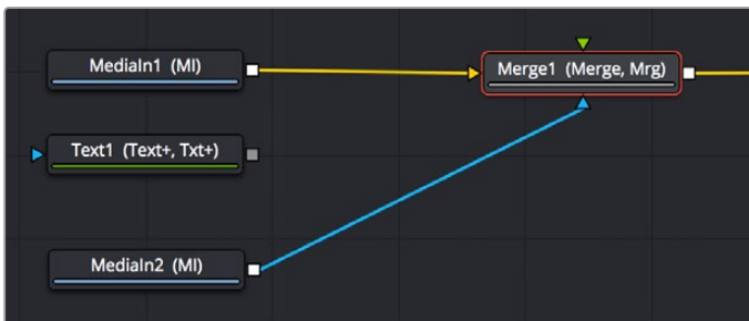
更新済みの合成。2つのビデオイメージが接続されてテキストノードの 接続が解除された状態
