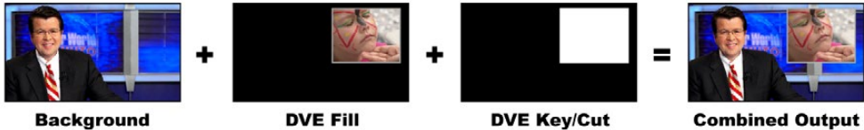
Combining a background, DVE fill and DVE key/cut
