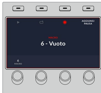
Durante la registrazione un bordo rosso circonda il display LCD
