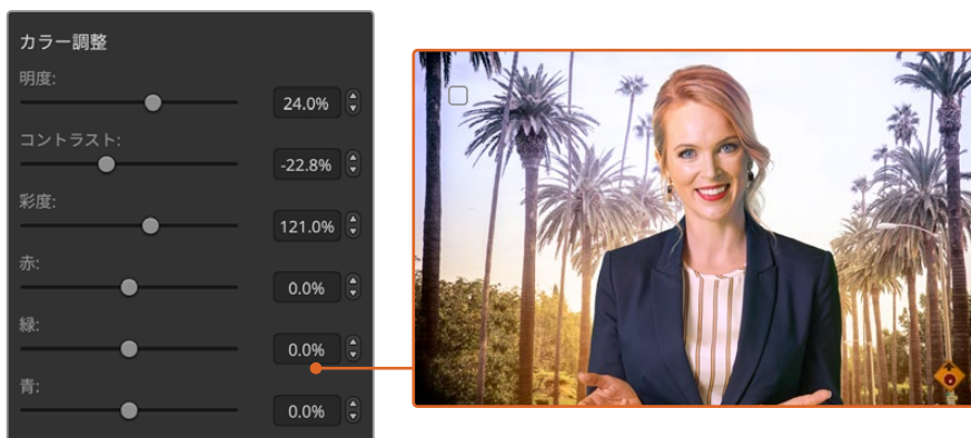
カラー調整コントロールを使用して、フォアグラウンドとバックグラウンドを調和
