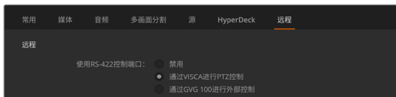
将RS-422远程端口设为禁用、VISCA或GVG
