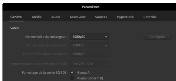
Régler le niveau de la sortie 3G SDI
