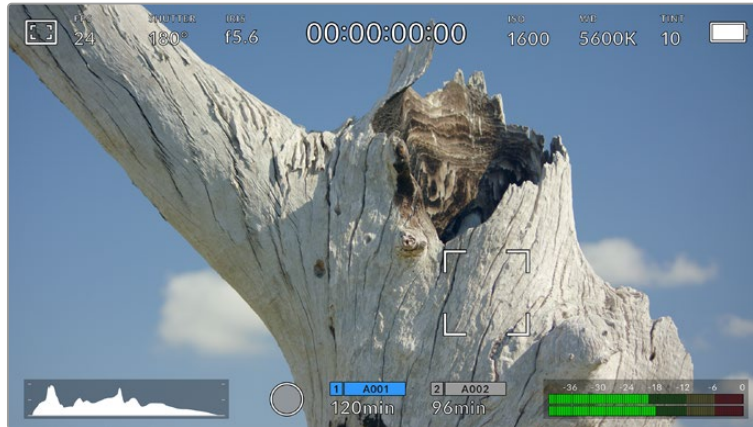
Touch-LCD der URSA Mini mit Fokussierung per Druck-Touch
