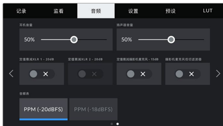
URSA Mini Pro 12K系列型号和URSA Mini Pro G1上的“音频表”设置
