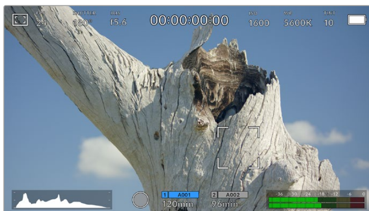
Lo schermo touch di URSA Mini con la funzione di messa a fuoco con un tocco
