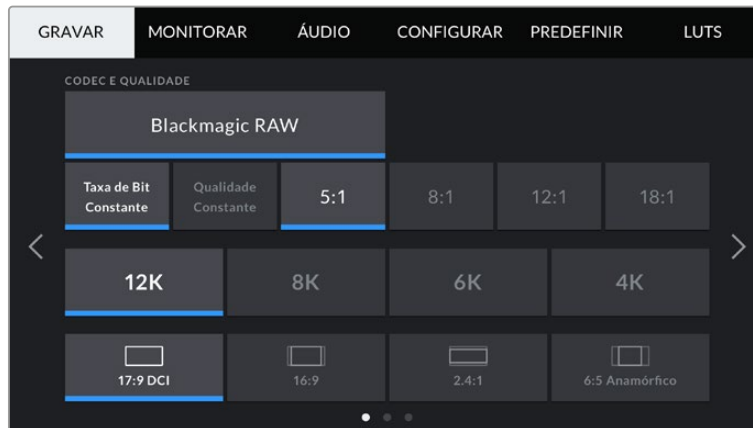
Primeira página das configurações de gravação nos modelos URSA Mini Pro 12K.
