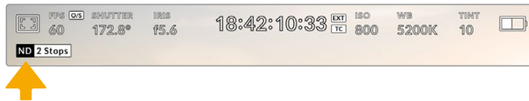
调整URSA Mini Pro的ND滤镜设置将调出ND滤镜标识
