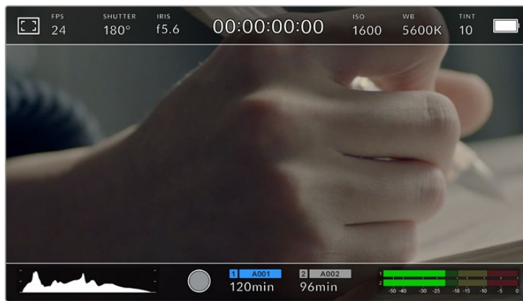
URSA Mini LCD-Touchscreen mit aktivierten 2,40:1-Bildrandmarkierungen
