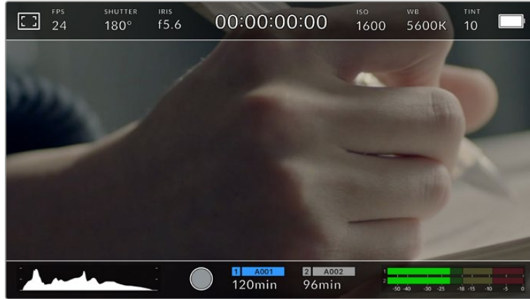
2.40:1 프레임 가이드가 적용된 URSA Mini LCD 터치스크린
