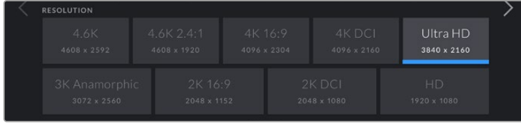
URSA Mini Pro 4.6K G2 ve URSA Mini Pro 4.6K kameralarda 'çözünürlük' seçenekleri
