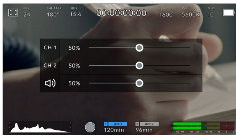
URSA MiniのLCDタッチスクリーンでオーディオメーターをタップし、ボリュームおよびヘッドセット/スピーカー設定へ簡単にアクセス
