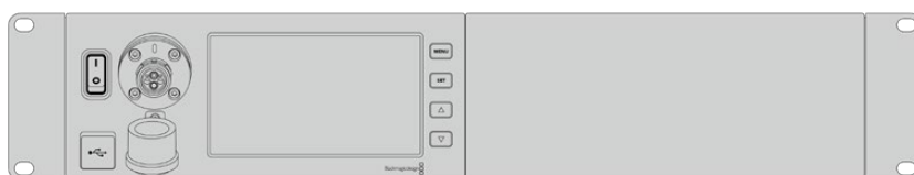
La plaque d'obturation peut être utilisée pour cacher la partie vide du rack
