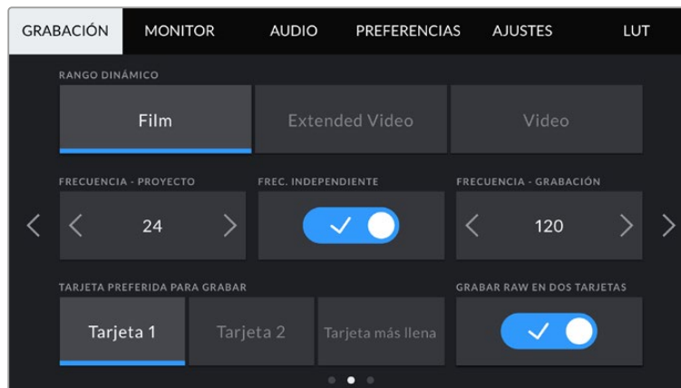
Los modelos URSA Mini Pro 12K ofrecen una opción para grabar en formato RAW en dos tarjetas. Dicha opción está desactivada en el resto de cámaras URSA Mini.
