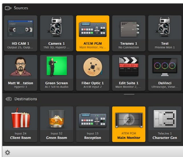
Blackmagic Videohub Controlソフトウェアで、1つのコントロールパネルから複数のソースおよび送信先を管理、ルーティング。
