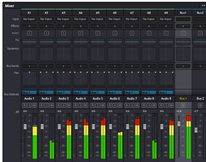
オーディオミキサー。タイムラインのトラックごとにチャンネルストリップがあります。
