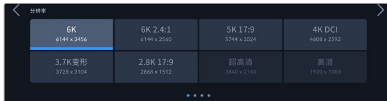
使用Blackmagic RAW编解码格式时，Pocket Cinema Camera 6K Pro和6K G2的“分辨率”选项。
