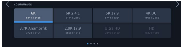
Blackmagic RAW kodeğini kullanırken, Pocket Cinema Camera 6K ve 6K G2 'çözünürlük' seçenekleri.
