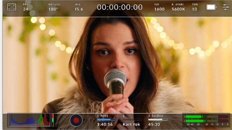
2.40:1 çerçeve kılavuzları etkinleştirilmiş dokunmatik LCD ekran
