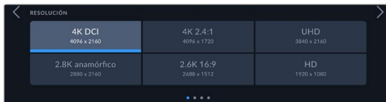
Opciones RESOLUCIÓN en el modelo Blackmagic Pocket Cinema Camera 4K. Cabe destacar que, en el formato DCI 4K, la categoría se denomina RESOLUCIÓN , mientras que en los otros es RESOLUCIÓN - ÁREA DEL SENSOR REDUCIDA .
