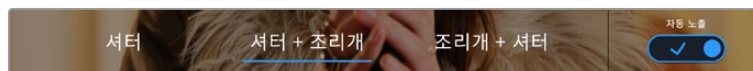
'셔터' 메뉴에서 '자동 노출' 을 누르면 셔터 기반의 자동 노출 모드로 접속할 수 있습니다.
