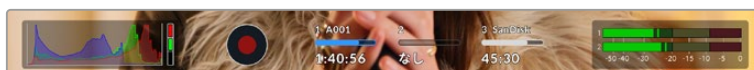
LCDタッチスクリーン底部のストレージインジケータは、録画可能時間と、SDカードのロックの有無を表示
