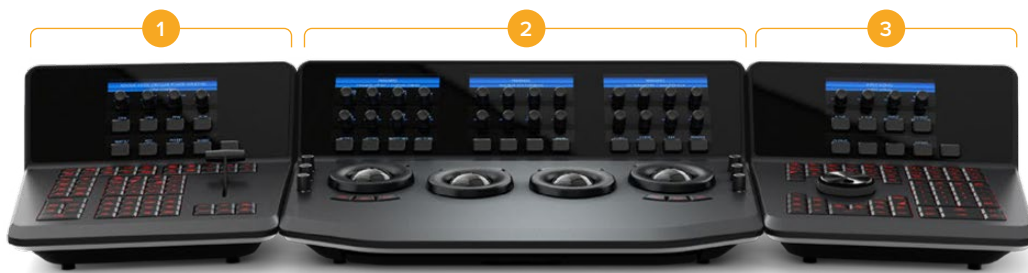
1. Módulo con palanca 2. Módulo con esferas 3. Módulo con mando de búsqueda
