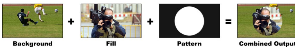
将背景和填充及图案键进行合成
