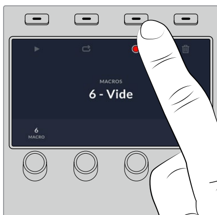
Appuyez sur le bouton d'enregistrement pour commencer l'enregistrement de votre macro.
