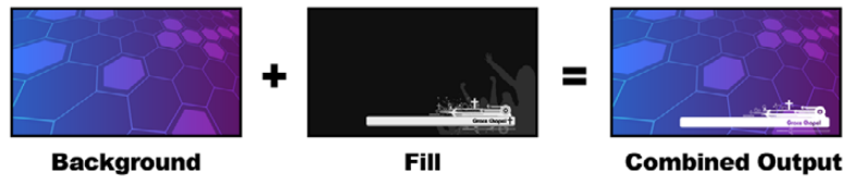
Bir luma key'de, arkaplanı ve fill/key sinyalini birleştirme
