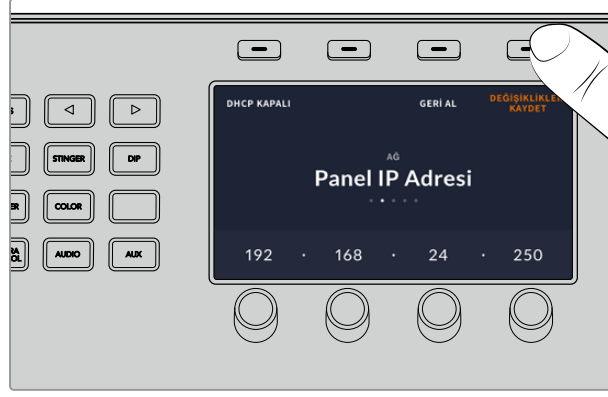
Ağ ayarlarınızdan memnun olduğunuzda, “save changes” (değişiklikleri kaydet) yazılım butonuna basarak onaylayın
