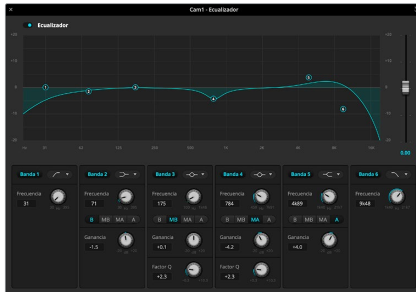
Cada entrada de audio cuenta con un ecualizador paramétrico de seis bandas.
