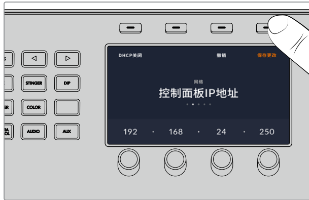
网络设置完毕后,按“保存更改”多功能按钮以确认设置
