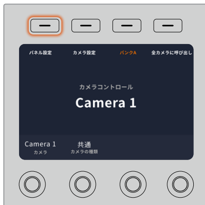
LCDのホームスクリーンで「パネル設定」ソフトボタンを押して、カメラコントロールパネルのすべての設定にアクセス
