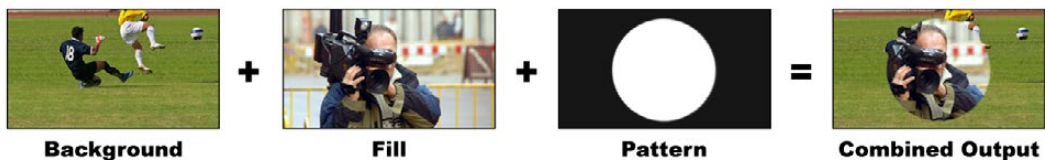
バックグラウンドとフィル/パターンキーの結合
