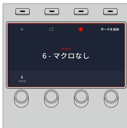
マクロの記録中、LCDの周囲に赤いボーダーが表示されます。
