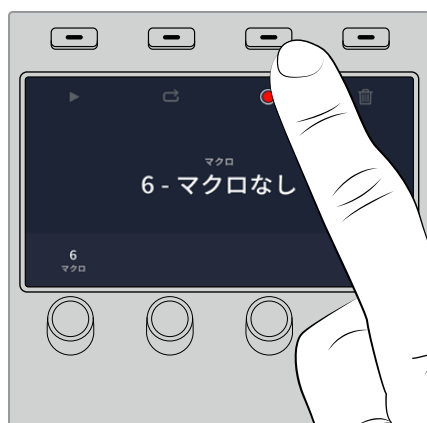
記録アイコンのソフトボタンを押して、マクロの記録を開始します。
