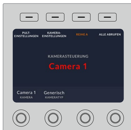
Am auf der LCD-Startseite eingeblendeten Kameranamen bzw. an der Kameranummer ist zu erkennen, welche Kamera aktuell für eine CCU ausgewählt ist
