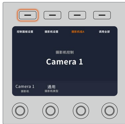
按下LCD屏幕主页上的“控制面板设置”对应的多功能按钮可进入摄影机控制面板所有设置
