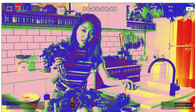
在一个曝光合理的画面中，肤色调会用绿色和粉色伪色来表示。
