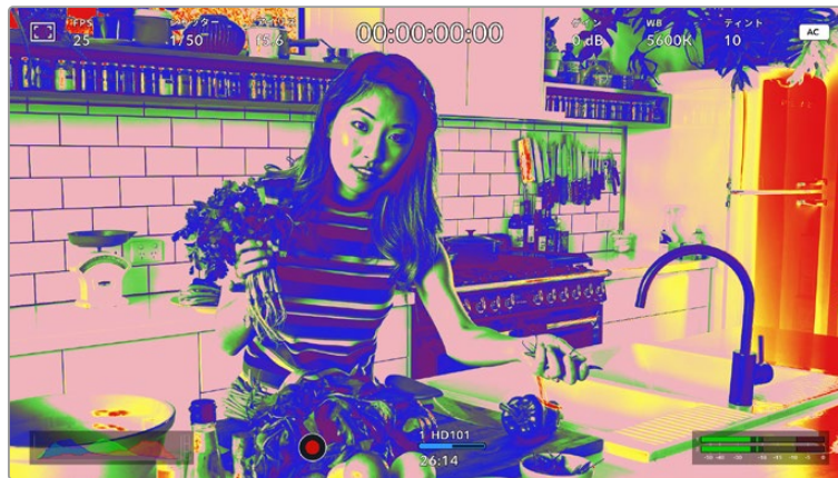
適切に露出されたイメージでは、スキントーンは緑とピンクのフォルスカラーで表示
