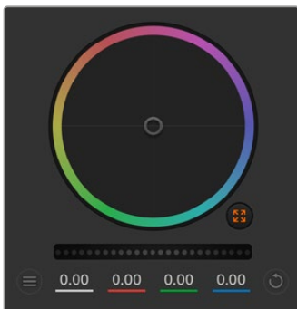
ホイールコントロールを左右にドラッグしてマスターホイールを調整
