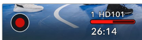
Индикатор носителя показывает имя накопителя, а также оставшееся время записи
