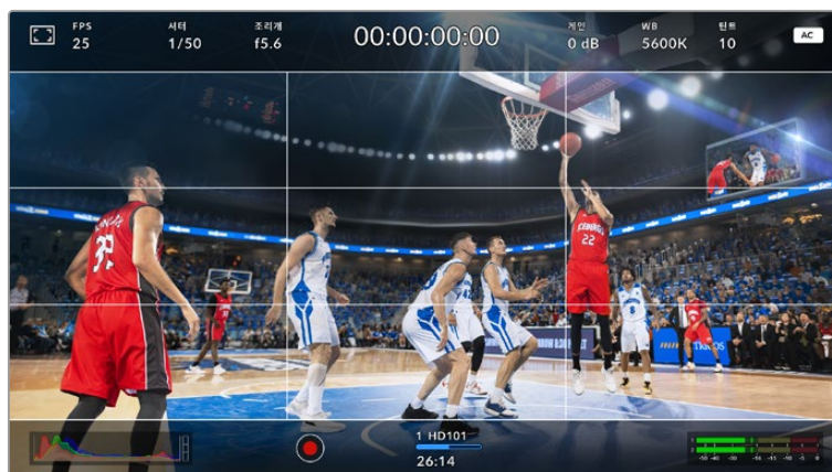
3분할 선 그리드는 모든 온스크린 프레임 가이드에 맞게 자동으로 조정됩니다.
