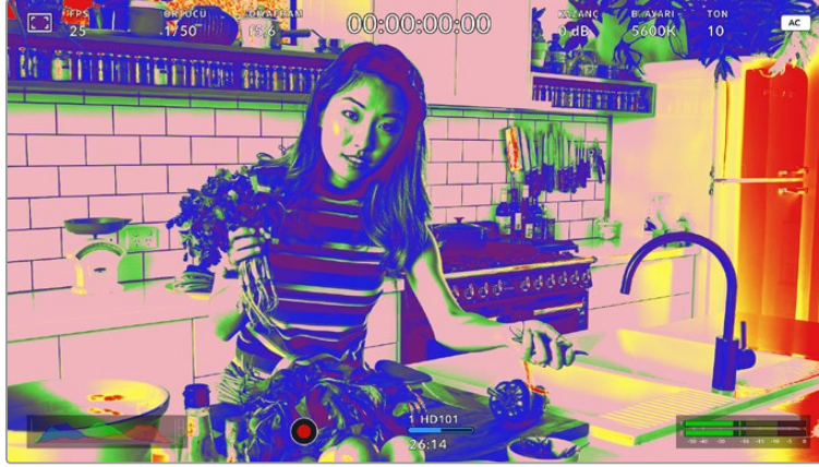
İyi pozlanmış bir görüntüde, cilt tonlarını yeşil ve pembe sahte renklerle temsil eder.
