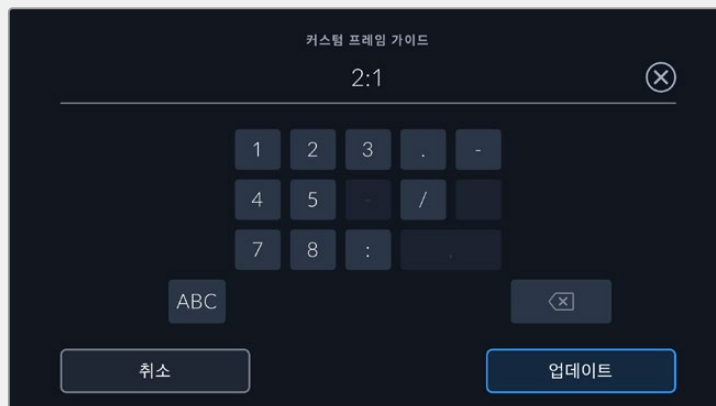
'커스텀 프레임 가이드'에서 숫자 키패드를 사용하여 새로운 종횡비를 입력하세요.
