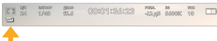
Значок LUT указывает на применение таблицы LUT к данному изображению
