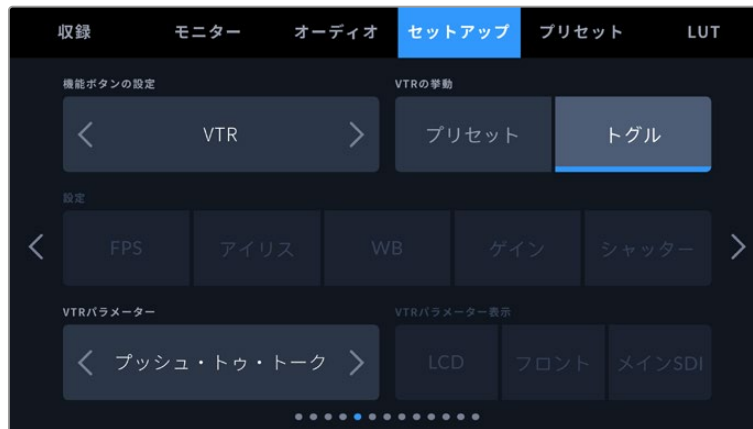
B4レンズの「VTR」ボタンを「プッシュ トゥ トーク」に割り当て
