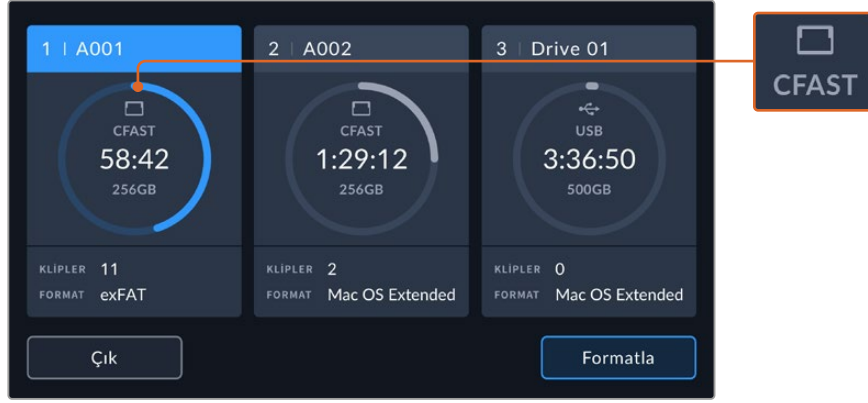
URSA Broadcast G2'deki depolama yöneticisi; CFast, SD, USB veya SSD ortamlardan hangisini şu anda kullandığınızı belirtir.
