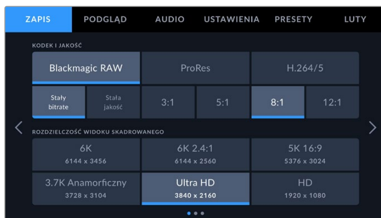
Domyślne ustawienia Blackmagic RAW w zakładce ZAPIS
