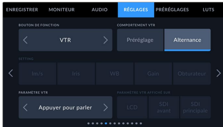
Configuration du bouton VTR sur la fonction Appuyer pour parler sur un objectif B4.
