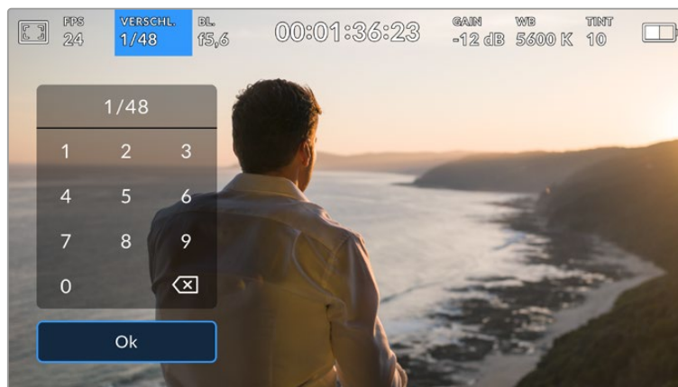
Über die Tastatur können Sie jeden gewünschten Wert für die Verschlusszeit eingeben
