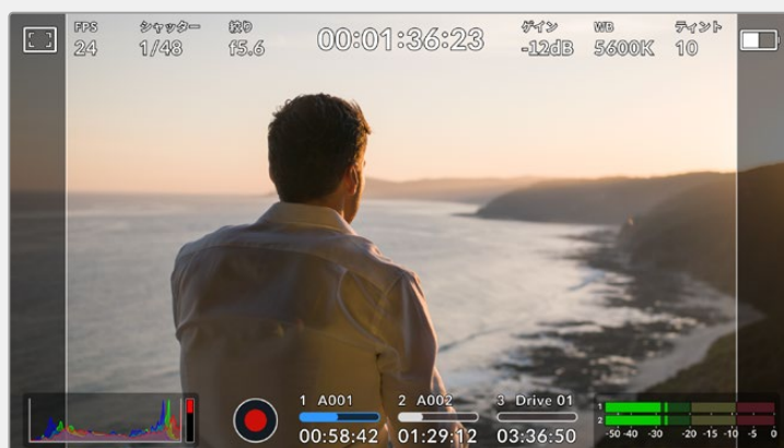
14:9フレームガイドを有効にしたURSA Broadcast G2のLCDタッチスクリーン
