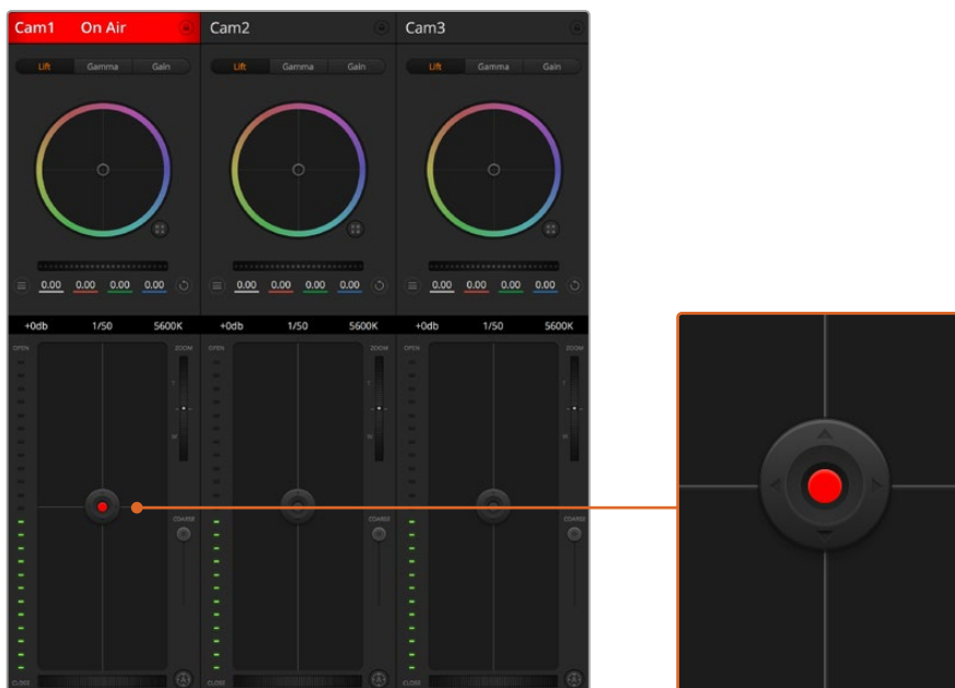
該当のカメラがオンエアされている場合、アイリス/ペDESTALレベル・コントロールは赤く光ります。
