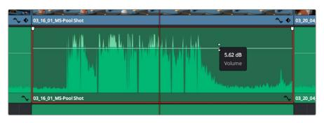
拖动音量叠加显示来调整片段电平
