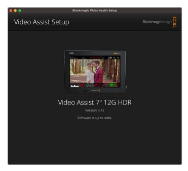
Per aggiornare il software interno di Video Assist, collegalo con un cavo USB al computer, poi scarica e lancia la versione più recente di Blackmagic Video Assist Utility. Segui le istruzioni sullo schermo. Se la finestra non appare, il software interno è aggiornato
