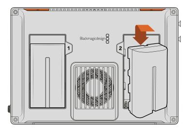
Coloque la batería en el espacio correspondiente y deslícela hasta que calce en su lugar. Para retirarla, mantenga presionado el botón arriba de la batería y deslícela.
