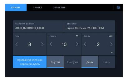
Когда монитор-рекордер находится в режиме воспроизведения, в поле «Табличка данных» выводится имя клипа и доступна кнопка «Хороший дубль». В режиме ожидания в поле «Табличка данных» отображается текст «Следующий клип» и доступна кнопка «Последний клип как хороший дубль».
