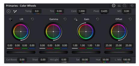
'Lift', 'gamma', 'gain' ve 'offset' renk tekerleri, kliplerinizin renk ve tonlama dengesi üzerinde tam kontrol sağlar. Her bir tonlama bölgesi için renklerin tümüne aynı ayarlamayı yapmak üzere, renk tekerlerinin altında bulunan kadranı, ileri ve geri sürükleyin.
