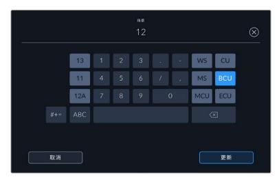
输入"场景"元数据时, Video Assist的屏幕键盘左侧会提供场景号建议, 右侧会提供拍摄镜头类型。
