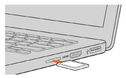
将SD卡插入计算机的SD卡槽中即可浏览卡内的素材片段。
