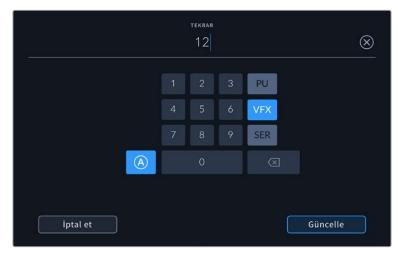
Tekrar numarasının otomatik olarak artması için, 'standby' (bekleme) modundayken, 'A' üzerine tıklayın. Bu, kaydedilen her klip için tekrar numarasını, otomatik olarak artıracaktır. Etkinleştirildiğinde, küçük bir 'A' simgesi, çekim tahtasındaki tekrar numarasının yanında belirir. Tekrar metaverisini girerken, dokunmatik klavyenin sağında ek çekim bilgileri belirir.
