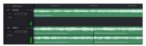
А1 — монодорожка с одной полосой, А2 — стереодорожка с двумя полосами
