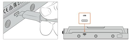
Conecte seu Video Assist a um computador usando um cabo USB-C.
