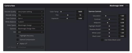
'Camera RAW' 탭에서 'Decoding Using'을 'Clip'으로 설정하면 사용하는 클립의 Blackmagic RAW 설정을 조절할 수 있습니다.
