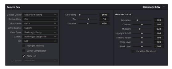
在"Camera Raw"选项卡中,从"解码方式"菜单中选择"片段",可调整单个片段的Blackmagic RAW设置
