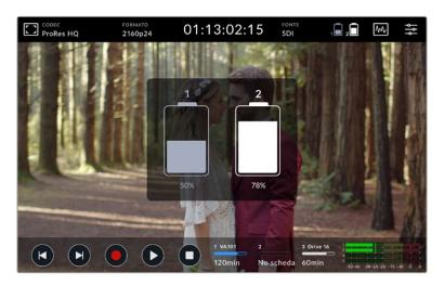
Quando è in funzione, Video Assist utilizza la batteria con meno carica fino a scaricarla completamente, poi passa senza interruzioni alla seconda batteria. L'icona della batteria si illumina di rosso quando la carica residua è inferiore al 25%.
