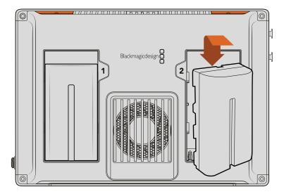
Insira a bateria no compartimento e deslize para baixo até que ela trave no lugar. Para retirar, pressione e segure o botão localizado acima da bateria e deslize-a para fora.
