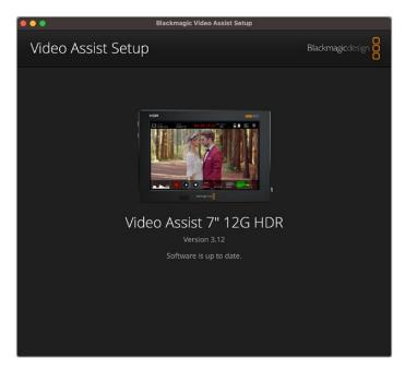
Чтобы обновить ПО, подключите Video Assist к компьютеру через порт USB, затем загрузите и запустите последнюю версию утилиты Blackmagic Video Assist Setup. Следуйте инструкциям на экране. Если инструкции не появятся, Blackmagic Video Assist имеет актуальную версию ПО.
