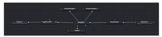
Der 2D- oder 3D-Merge-Node ist das meistgebrauchte Tool. Dieser Node fungiert als Drehscheibe, der Tools im Node-Editor in einen einzelnen Ausgang zusammenführt
