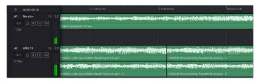
A1轨道的轨道标头显示了一条轨道的单音轨代表了单声道音频,而A2轨道标头则显示了两条轨道的立体音轨代表了自适应立体声音频。
