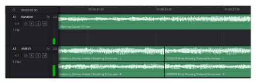
O cabeçalho de trilha A1 indica uma trilha mono como uma única pista para áudio mono, e o cabeçalho de trilha A2 indica uma trilha estéreo com duas pistas enquadrando o som estéreo.
