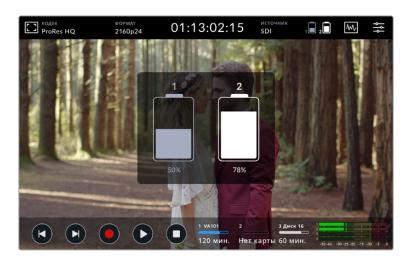
Blackmagic Video Assist сначала использует батарею с более низким уровнем заряда, а затем переключается на вторую, что позволяет избежать сбоев в работе. Если заряд опускается ниже 25%, значок загорается красным цветом.
