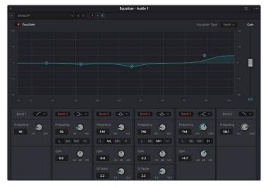
Каждую дорожку можно обработать с помощью шестиполосного параметрического эквалайзера
