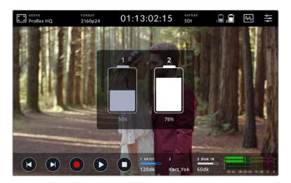
Çalışma esnasında, Video Assist cihazınız önce en düşük şarjlı bataryayı kullanacaktır ve ardından, bu batarya tükendiğinde kesintisiz olarak diğerine geçiş yapacaktır. Batarya kapasitesi %25'in altına düştüğünde, batarya ikonu kırmızı yanacaktır.
