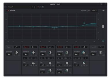
L'equalizzatore parametrico a 6 bande applicabile a ogni traccia
