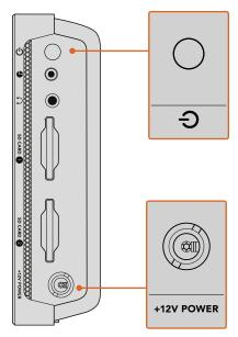
Соедините источник внешнего питания со входом +12V Power. Нажмите кнопку питания, чтобы включить устройство.
