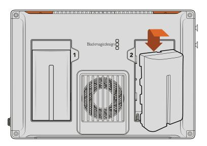
バッテリーをスロットに挿入し、ロックされるまで押し込みます。バッテリーを取り出すには、バッテリーの上にあるボタンを押し、バッテリーをスライドさせて取り出します。
