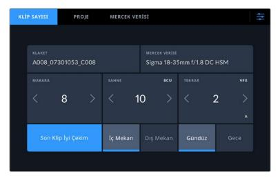
Video Assist 'oynatım' modundayken, 'çekim tahtası' sekmesi, çekim tahtasını ilgilendiren klibi tanımlar ve 'iyi çekim' butonunu gösterir. Bekleme modunda, çekim tahtası bir sonraki klip içindir ve 'son klip iyi çekim' butonunu gösterir.
