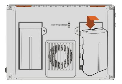
Inserisci la batteria nell'alloggiamento e falla scorrere fino a sentire un clic. Per rimuoverla, tieni premuto il pulsante sopra la batteria ed estraila facendola scorrere
