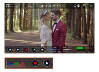
La barra inferiore include i controlli di trasporto, gli indicatori dei supporti di memoria e i livelli audio. Dal menù puoi anche abilitare un istogramma che verrà visualizzato al posto delle icone skip nella parte inferiore sinistra dello schermo.
