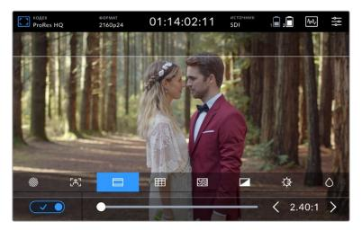
Соотношение сторон 2,40:1 часто используется для кадрирования при работе с материалом, который предназначен для показа на широких экранах
