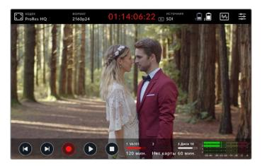
Ha Blackmagic Video Assist 12G HDR верхняя панель инструментов содержит тайм-код, который во время записи отображается красным цветом
