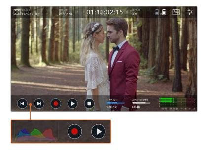
Alttaki araç çubuğu ise; aktarım kontrollerini, depolama göstergelerini ve ses göstergelerini içerir. Araç çubuğunun sol alt köşesindeki atlama butonlarının üstünde belirmesi için, menü üzerinden bir ekran histogram'ı da etkinleştirilebilir.
