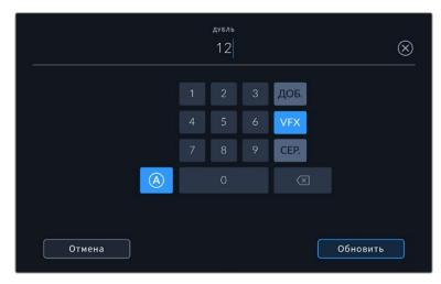
В режиме ожидания нажмите на значок «А», чтобы автоматически присваивать номера дублям при записи клипов. Когда эта функция включена, рядом с числовым значением отображается буква «А». При вводе метаданных поля «Дубль» справа от клавиатуры предлагаются некоторые типы кадров.
