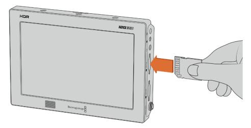
Kayda başlamak için, HFS+ veya exFAT formatlı bir UHS-I ya da UHS-II SD kartını yerleştirmeniz gerekecektir. Dokunmatik ekran menüsündeki 'depolama' ayarlarını kullanarak, SD kartınızı kolayca formatlayabilirsiniz.
