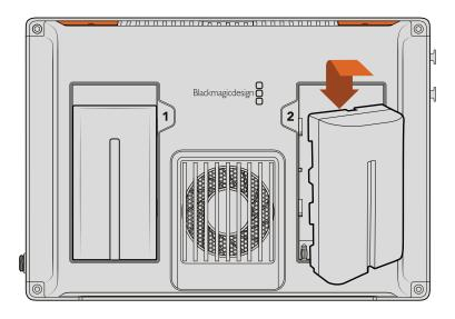
将电池放进插槽,向下滑动直到锁定到位。如要取出电池,按住电池上方的按钮将电池滑动拿出。
