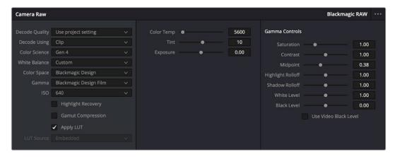
Na aba "RAW de Câmera", selecione "Clipe" a partir do menu suspenso "Decodificar Usando" para fazer ajustes nas configurações Blackmagic RAW do seu clipe.
