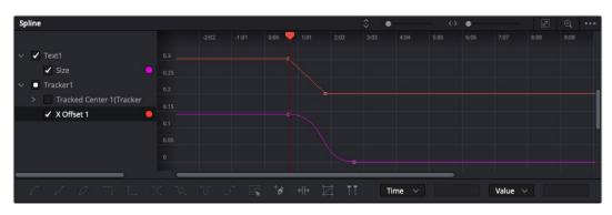
图中的"大小调整"关键帧动画已经被平滑处理为一条贝塞尔曲线。您可以点击贝塞尔手柄,缩短或拉长曲线,或者点击关键帧方块图标移动关键帧位置。
