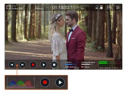
Нижняя панель инструментов содержит органы управления воспроизведением, индикаторы накопителей и звука. Отображение гистограммы поверх кнопок перемотки в нижнем левом углу можно также включить из меню.
