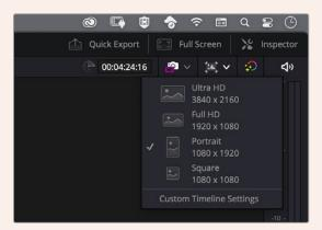
Configure a linha de tempo para proporções de tela verticais usando o menu rápido de resolução da timeline.
