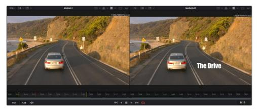
时间标尺上的黄色标记代表片段在时间线上的入点和出点。如果您使用Fusion片段或复合片段,时间标尺会只显示时间线上的片段时长,不显示余量。
