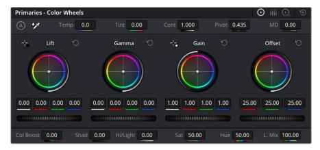
Os discos de cores "Pedestal", "Gama", "Ganho" e "Deslocamento" oferecem controle total sobre o balanço de cores e o equilíbrio tonal dos seus clipes. Para realizar um ajuste uniforme de todas as cores para cada região tonal, arraste o dial abaixo dos discos de cores para frente e para trás.
