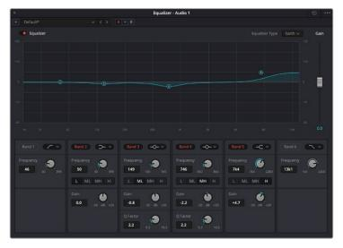
Parametrischer 6-Band-Equalizer, der auf jede Spur angewendet werden kann
