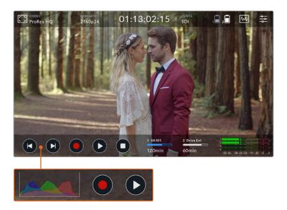
A barra de ferramentas inferior inclui controles de transporte, indicadores de armazenamento e medidores de áudio. A exibição de um histograma também pode ser ativada através do menu para aparecer sobre os botões de avanço e retrocesso na parte inferior esquerda da barra de ferramentas.
