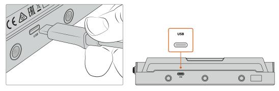
Подключение модели Video Assist к компьютеру с помощью кабеля USB-C
