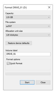
在Windows计算机上可使用"格式化"对话框将您的存储介质格式化为exFAT格式。
