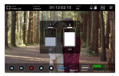
Durante a operação, o seu Video Assist usará a bateria com menos carga primeiro e, depois, passará para a outra sem interrupção quando exaurida. O ícone da bateria ficará vermelho assim que a capacidade restante for inferior a 25%.
