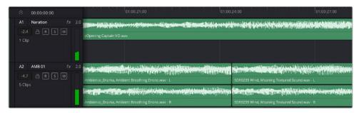
L'intestazione della traccia A1 mostra una corsia singola di audio mono; l'intestazione della traccia A2 mostra due corsie di audio stereo
