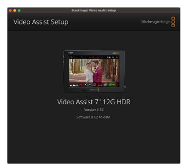
Video Assist의 내부 소프트웨어를 업데이트하려면, USB 포트를 통해 제품을 컴퓨터에 연결한 뒤, 최신 버전의 Blackmagic Video Assist Setup을 다운로드하여 실행하세요. 화면의 메세지에 따르세요. 이미 최신 버전의 내부소프트웨어가 설치된 경우, 화면에 아무런 메시지가 나타나지 않습니다.
