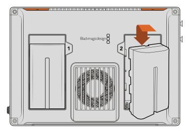
Bataryayı yuvaya yerleştirin ve yerine oturana dek aşağı kaydırın. Çıkartmak için, bataryanın üstündeki butonu basılı tutun ve bataryayı yerinden kaydırarak çıkarın.
