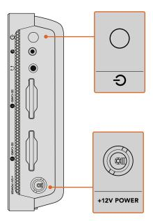
+12V güç girişine harici güç kaynağını bağlayın. Cihazı çalıştırmak için güç butonuna basın.
