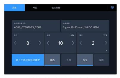
当Video Assist在播放模式下时,"场记板所属片段"可识别场记板适用的片段,并显示"好镜次"按钮。在待命模式下时,场记板用于"下一个片段",并显示"将上个片段标为好镜次"按钮。
