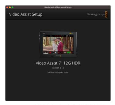
要升级Video Assist的内部软件,请通过USB端口将设备连接到您的计算机,然后下载并运行最新版Blackmagic Video Assist Setup实用程序。根据屏幕提示操作。如果系统未弹出任何提示,则说明您的内部软件已经是最新版本。
