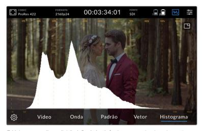
O histograma exibe a distribuição da luminância, ou o contraste entre pretos e brancos ao longo de uma escala horizontal.
