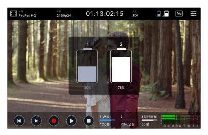
Video Assist는 배터리가 모자랄 경우 잔량이 적은 배터리를 먼저 사용한 후, 작업의 방해 없이 다음 배터리를 사용합니다. '배터리' 아이콘은 잔량이 25% 이하일 경우, 빨간색으로 변합니다.
