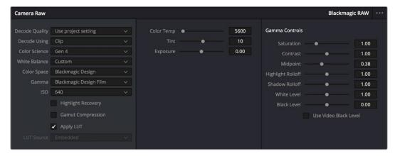
Чтобы изменить настройки Blackmagic RAW для отдельного клипа, выберите «Клип» в раскрывающемся меню «Для декодирования использовать» на вкладке «Настройки RAW камеры»
