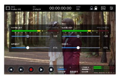
7英寸Video Assist机型的XLR音频电平也可以调整
