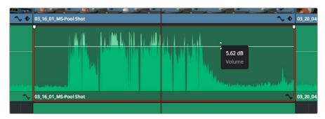
Klip seviyesini ayarlamak için, bir volüm katmanının sürüklenmesi
