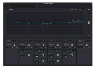
Ecualizador paramétrico de 6 bandas que puede aplicarse a cada pista
