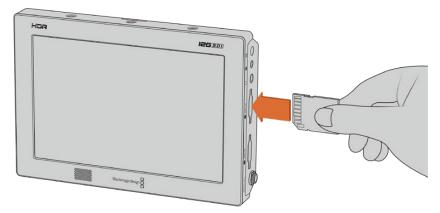
Чтобы начать запись, вставьте SD-карту класса UHS-I или UHS-II, отформатированную под файловую систему HFS+ или exFAT. Форматирование проще всего выполнить на мониторе-рекордере Video Assist в меню сохранения.
