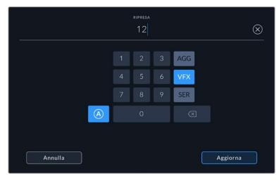
In modalità standby, tocca A per abilitare l'incremento automatico del numero di ripresa per ogni clip registrata. Una piccola A apparirà a lato della voce Ripresa nel ciak digitale. Quando inserisci i metadati di ripresa, a destra sulla tastiera touch compaiono varie opzioni per indicare il tipo di ripresa
