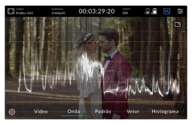
Monitor da forma de onda exibindo valores de luminância.
