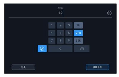
대기 모드에서 테이크 넘버가 자동으로 증가하도록 설정하려면 'A' 버튼을 누르세요. 이제 각 녹화 클립의 테이크 넘버가 자동 증가합니다. 이 기능이 활성화되면 슬레이트의 테이크 번호 옆에 'A'가 작게 표시됩니다. '테이크' 메타데이터를 입력하면 터치 키보드 오른쪽에 추가 숏 유형이 제시됩니다.
