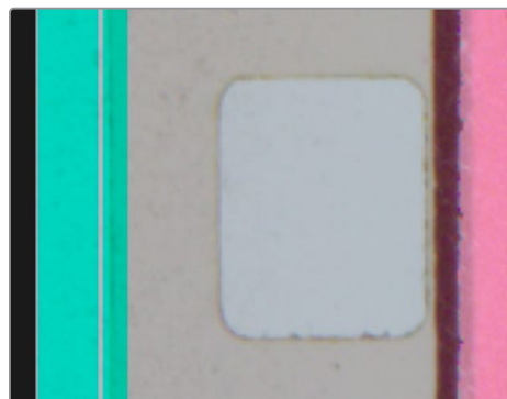
Installation correcte du 8mm. Pour la bande de stabilisation, la bande transparente se trouve dans la zone de support de film.
