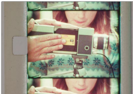
Die Kadra­ge­ver­schlü­ße sind bis an den Rand des inak­ti­ven Bild­be­reichs des Films kor­rekt ein­ge­stellt
