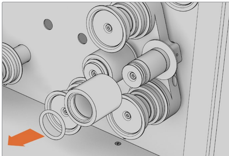
パーティクルトランスファー・ローラーを掃除するには、各PTRスピンドルのO形リングを取り外し、その後ローラーを外します。
