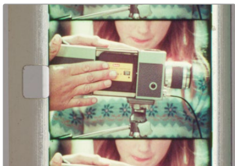
Некорректная установка: створки апертуры расположены слишком широко, поэтому по обе стороны изображения появляются светлые области
