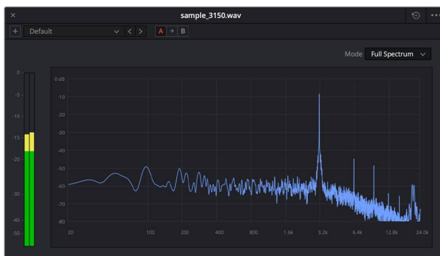
Пример трека с частотным анализом 3,15 кГц (детонация)
