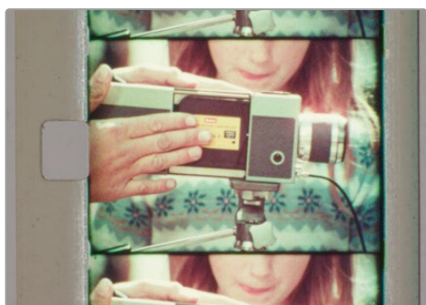
Правильне встановлення: ступки апертури коректно відрегульовані відносно країв неактивної області зображення
