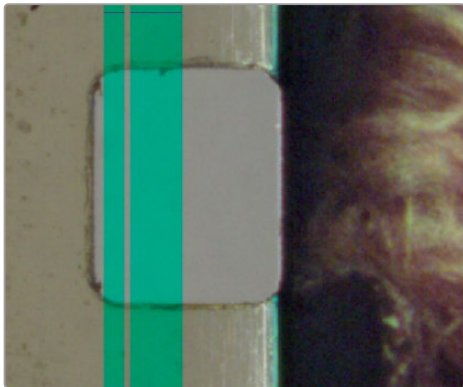
Inkorrekte 8mm-Einstellung. Das Overlay ist nicht korrekt auf die Perforationskante ausgerichtet
