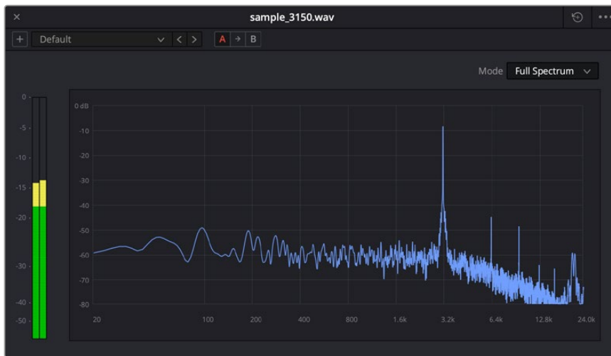
Приклад аудіодоріжки з частотним аналізом 3,15 кГц (детонація)
