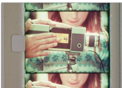
Configuración correcta: Las cortinillas se han ajustado correctamente para cubrir el área sin imágenes de la cinta.
