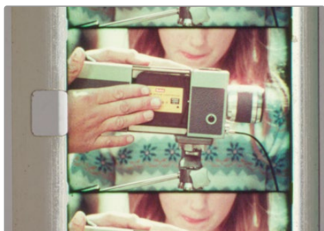
Неправильне встановлення: ступки апертури розташовані надто широко, тому з обох боків зображення з'являються світлі смуги
