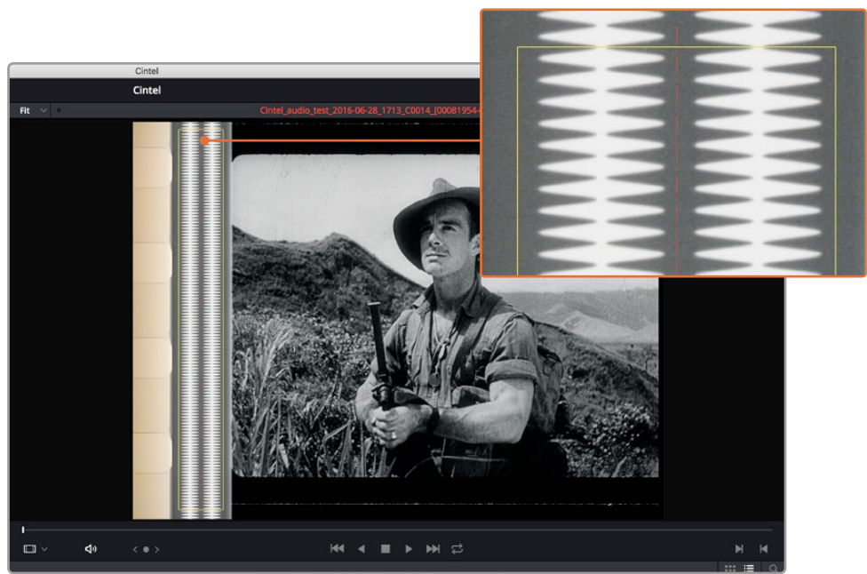
При включенной опции Show audio scan area (Показать область сканирования звука) на экран выводится рамка, которая позволяет видеть данные в области оцифровки звука и вести мониторинг процесса
