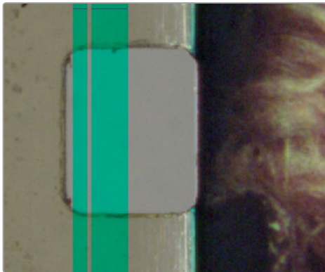
Configuração 8 mm incorreta. A sobreposição não está alinhada com a borda da perfuração.
