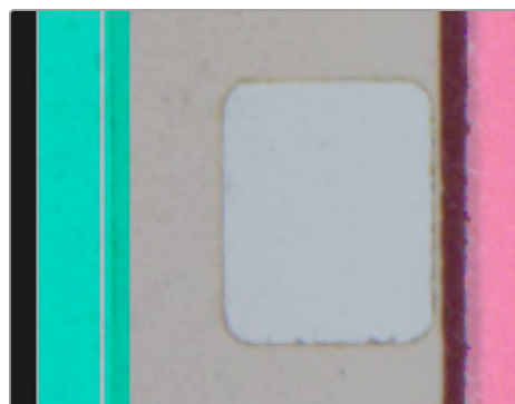
Posizionamento corretto dell'8mm. La banda trasparente della sovrapposizione rientra nell'area della base della pellicola.
