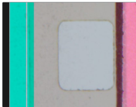
適切にセットアップされた8mm。スタビライズオーバーレイの水色のラインが、フィルムベースの領域内にあります。
