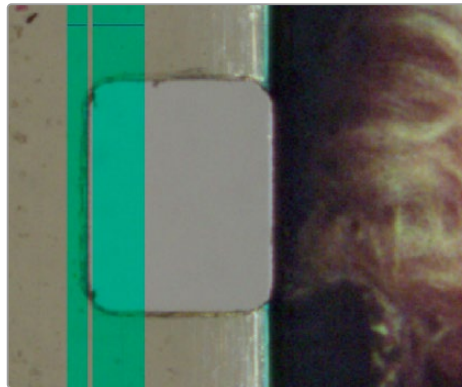
Configuração 8 mm correta. Para a sobreposição de estabilização, a posição padrão de alinhamento é na borda esquerda da perfuração, já que ela não é afetada pelo conteúdo da imagem. A faixa transparente na sobreposição de estabilização toca na borda da perfuração corretamente.
