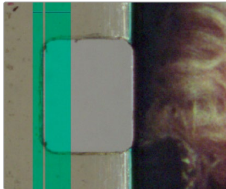
Korrekte 8mm-Einstellung. Die für das Stabilisierungs-Overlay standardmäßige Ausrichtung ist die linke Perforationskante, da diese nicht vom Bildinhalt beeinflusst wird. Die transparente Linie im Stabilisierungs-Overlay berührt die Perforationskante korrekt
