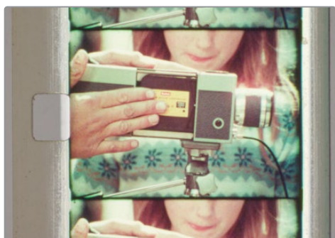
Installation incorrecte : les obturateurs d'ouverture sont trop larges, ce qui crée des zones lumineuses sur les deux côtés de l'image.
