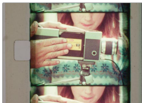
Неправильне встановлення: ступки апертури розташовані надто вузько, тому з обох боків зображення з'являються темні смуги
