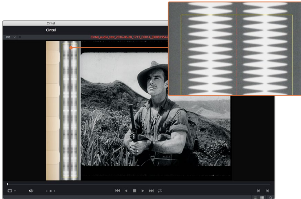
‘Show audio scan area’ 확인란을 선택하면 오디오 영역 가이드가 나타나 정확히 어떤 정보가 사용 중인지를 확인하고 추출 과정을 모니터링할 수 있습니다
