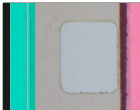
Posición correcta (8 mm). La línea transparente en la franja superpuesta está dentro del área de la base de la cinta.
