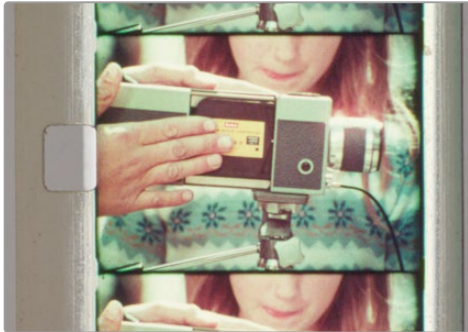
Inkor­rekt ein­ge­stell­te Kadra­ge­ver­schlü­ße ver­ur­sa­chen einen Licht­strei­fen an bei­den Sei­ten des Bilds
