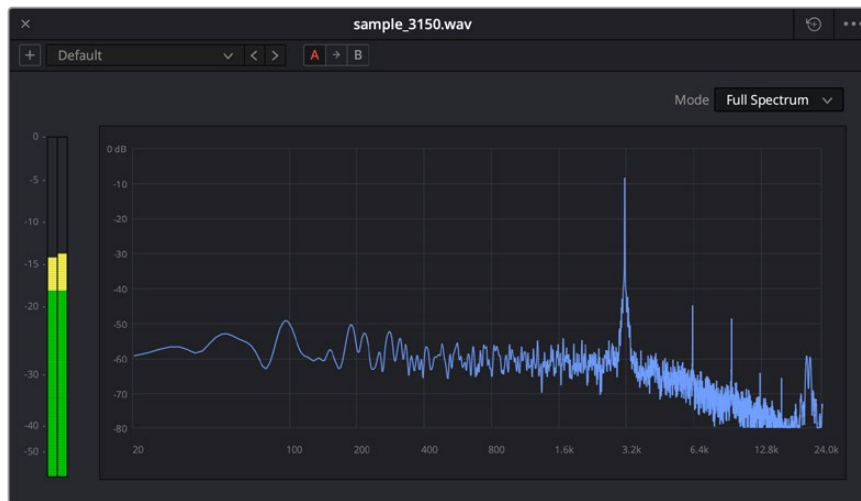
Letture di una traccia W&F 3,15kHz con lo strumento Frequency Analyser
