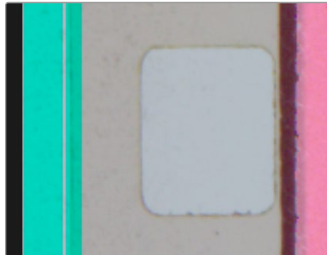
올바른 8mm 셋업. 안정화 오버레이의 경우, 오버레이의 투명한 스트립이 필름 베이스 영역 내에 존재합니다.
