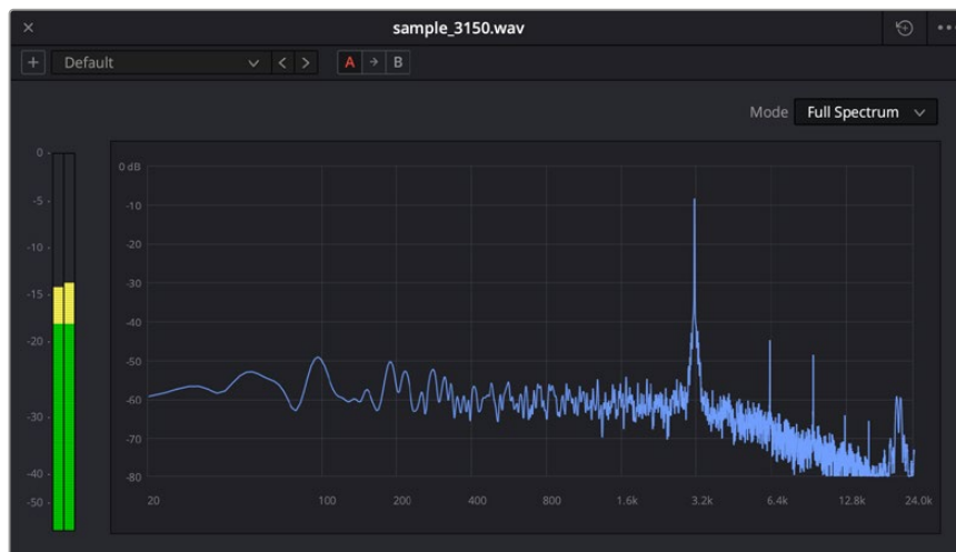
Przykład analizy częstotliwości ścieżki W&F 3,15 kHz
