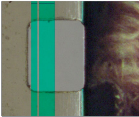
不正确的8mm设置。叠加显示位置没有与齿孔的边缘对齐。
