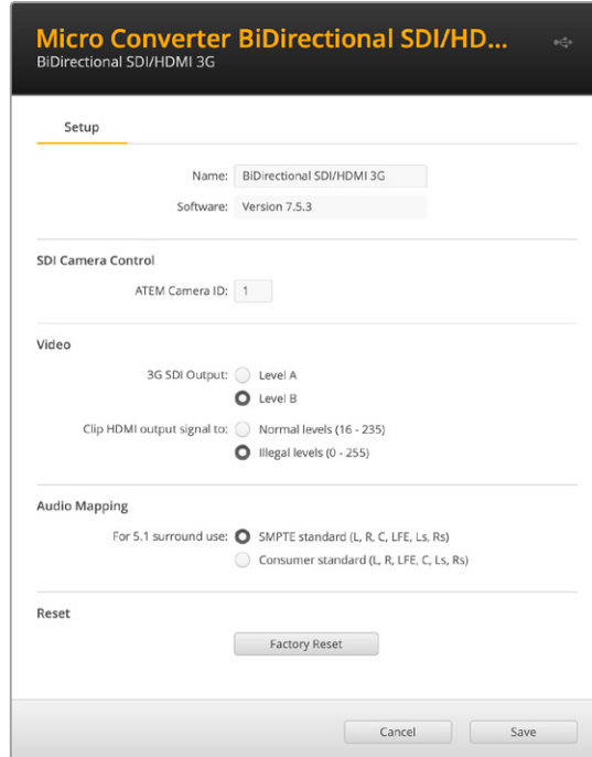
Micro Converter BiDirectional SDI/HDMI 3G의 설정 옵션
