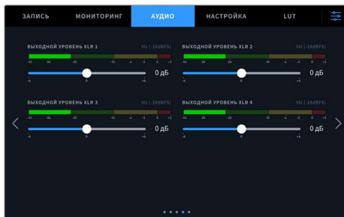
Слайдеры каналов служат для настройки уровня на XLR-выходах
