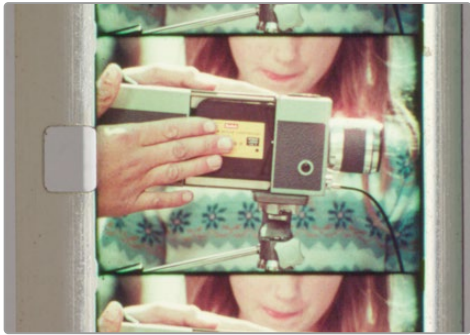
图为不正确的设置方式，光圈快门设置太宽，导致图像两侧均出现光区
