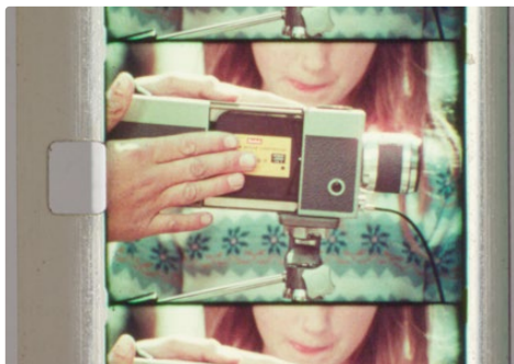
Posizionamento errato: l'apertura degli otturatori è troppo ampia e sono visibili aree di luce in entrambi i lati dell'immagine
