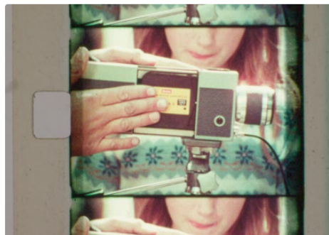
Posizionamento errato: l'apertura degli otturatori è troppo stretta e sono visibili aree scure in entrambi i lati dell'immagine
