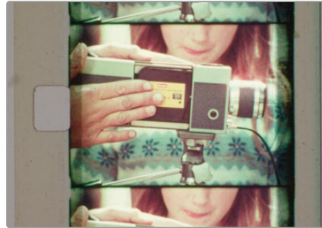
Inkorrekt eingestellte Kadrageverschlüsse verursachen dunkle Ränder an beiden Seiten des Bilds
