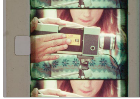
Yanlış kurulum, ışık deliği örtücüleri çok dar ayarlandığı için görüntünün her iki tarafında karanlık alanlar oluştuğunu göstermektedir
