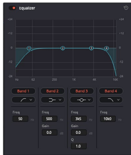
L'equalizzatore a 4 bande è applicabile a ogni clip nella timeline
