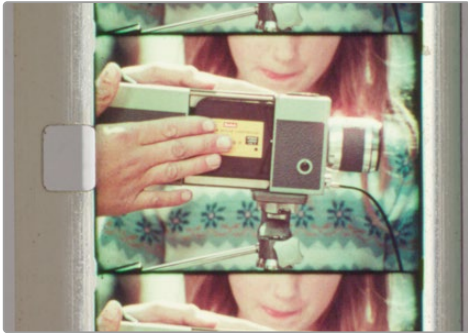
Inkorrekt eingestellte Kadrageverschlüsse verursachen einen Lichtstreifen an beiden Seiten des Bilds
