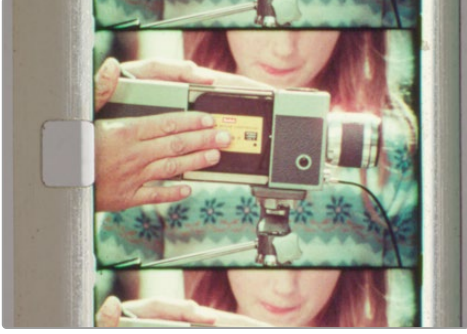
Yanlış kurulum, ışık deliği örtücüleri çok geniş ayarlandığı için görüntünün her iki tarafında parlak alanlar oluştuğunu göstermektedir
