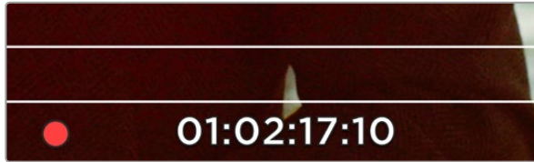
Blackmagic URSAの10インチLCD下部で点滅する赤い収録アイコン。コマ落ちが発生していることを示しています。
