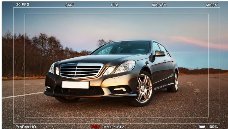
Auf „All“ eingestellte SDI-Overlays mit HDTV-Bildrandmarkierungen
