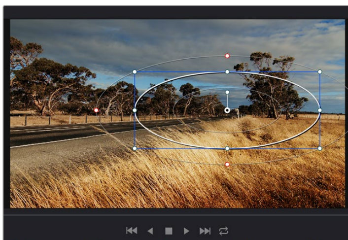
Power Windowを使用して、イメージ内の特定の部分にセカンダリーコレクションを適用できます。
