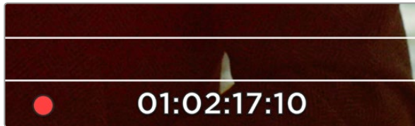
Die Blackmagic URSA zeigt ausgelassene Bilder unten am 10-Zoll-LCD durch Blinken des roten Aufnahme-Icons an
