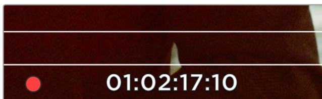
На Blackmagic URSA мигающий индикатор записи внизу ЖК-дисплея указывает на пропуск кадров
